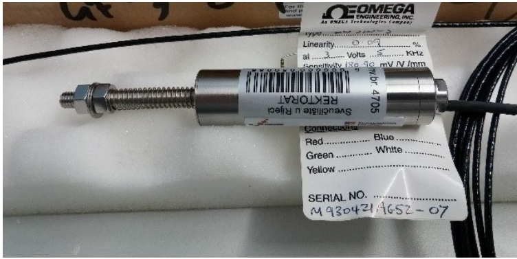
Slika 3. AC LVDT s nominalnim hodom \pm 5 mm
