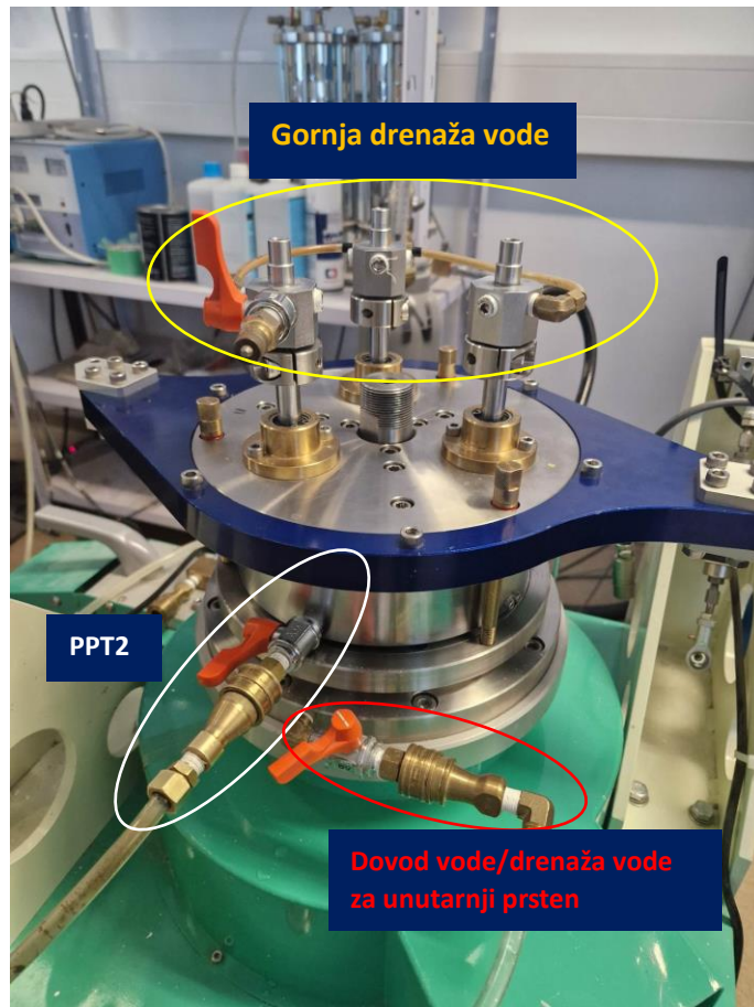
Slika 8.: Prikaz ventila, drenaže i mjerača pornih pritisaka
