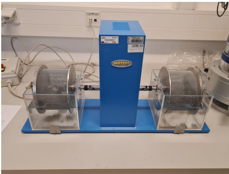
Slika 13. Uređaj za određivanje postojanosti stijene (eng. Slake Durability Test, SDT)
