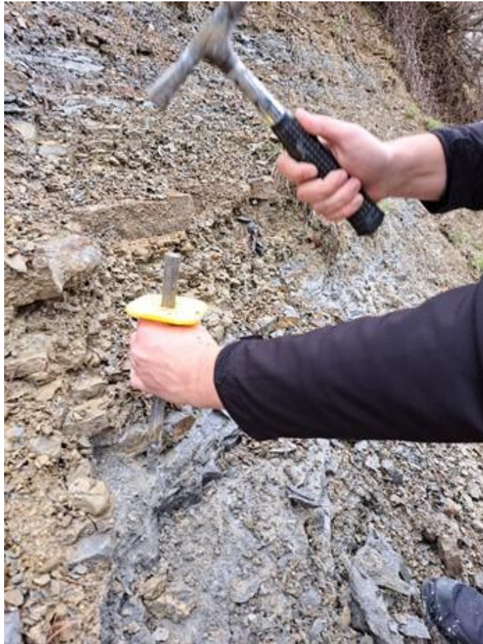
Slika 10. Uzimanje uzoraka za laboratorijsko ispitivanje s kosine.
