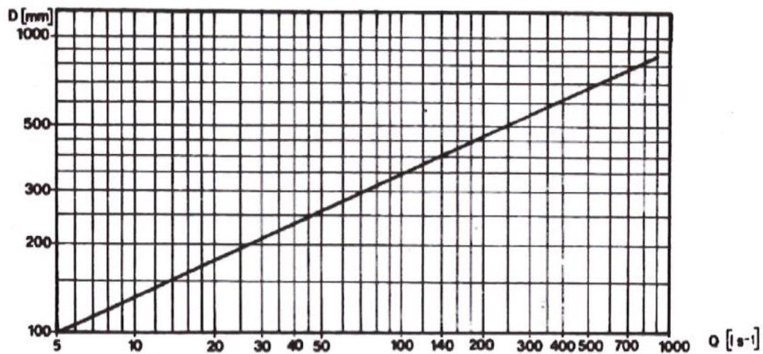
Slika 6 Dijagram ovisnosti unutarnjeg promjera cjevovoda i protoka [3]
