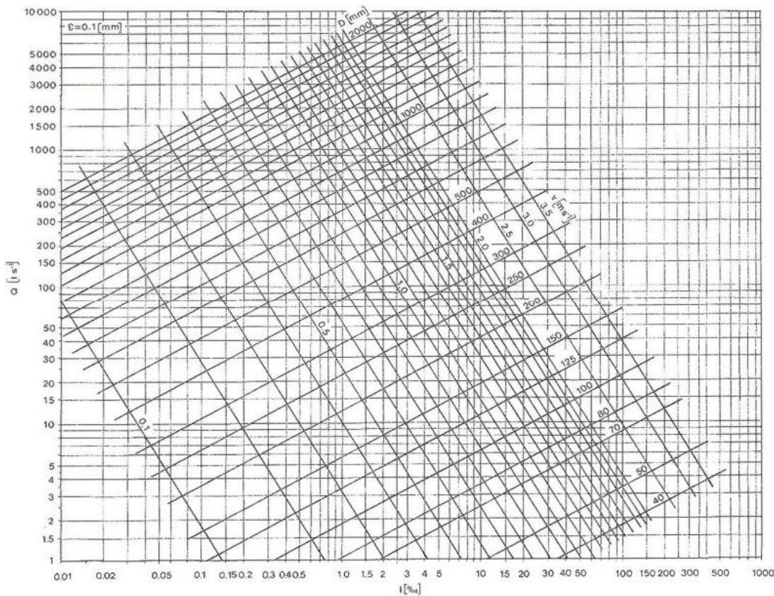
Slika 7 Nomogram hidrauličkih proračuna za okrugle cijevi [3]
