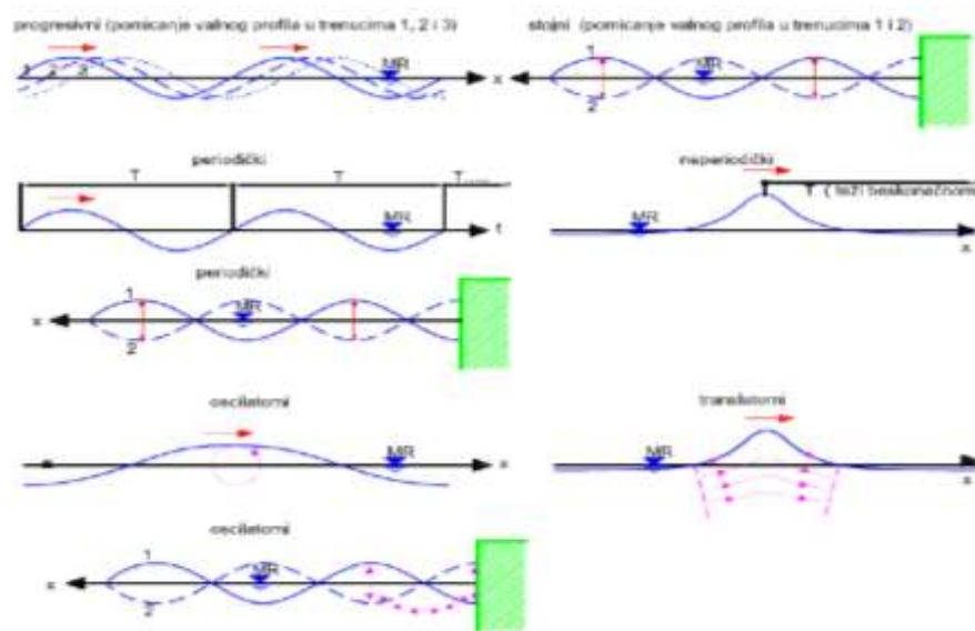
Slika 2. Modusi gibanja valnog profila i vodnih čestica [2]
