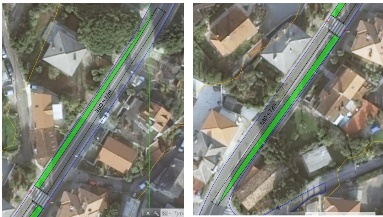
Slika 49. Grafički prikaz zaustavne preglednosti za pješački prijelaz 2 [13]
