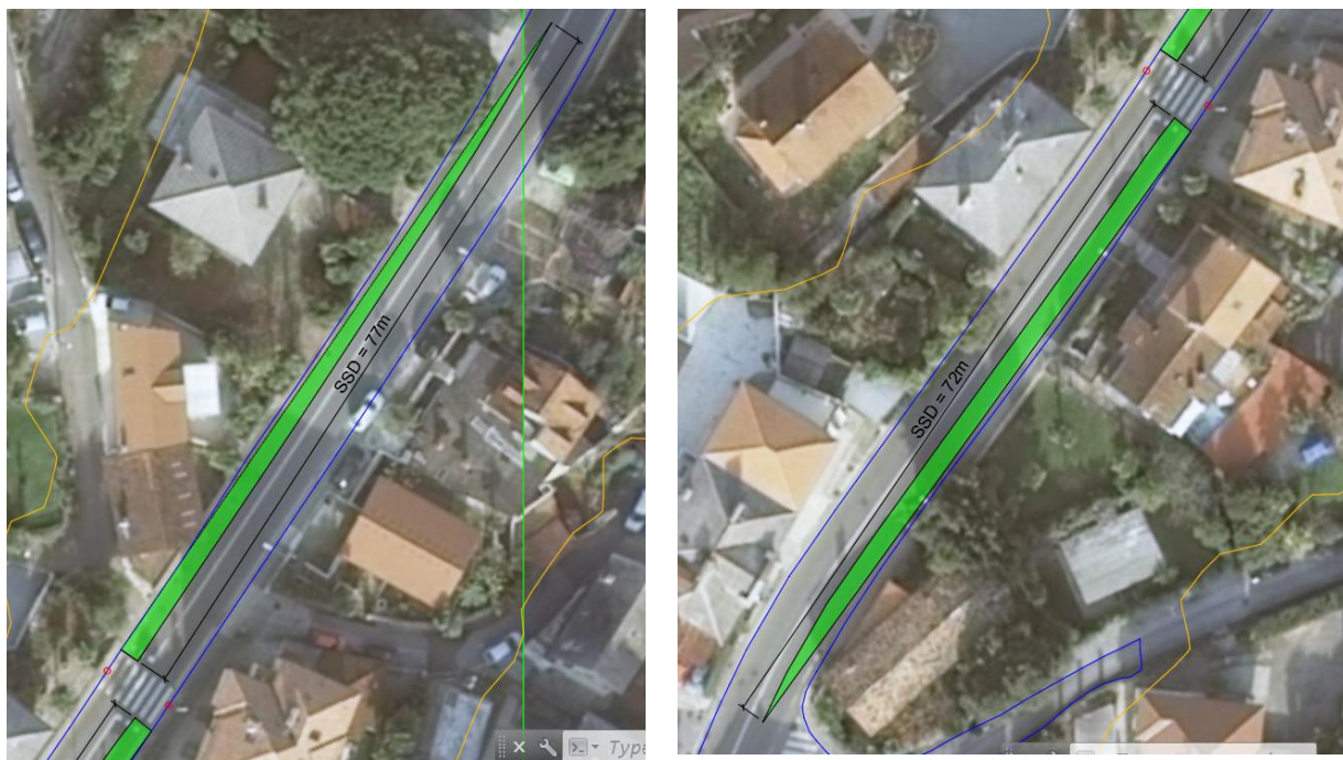
Slika 49. Grafički prikaz zaustavne preglednosti za pješački prijelaz 2 [13]
