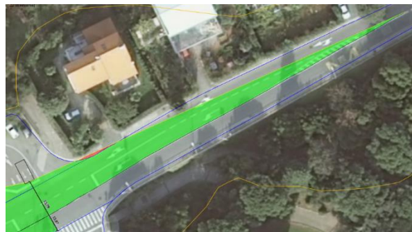
Slika 36. Grafički prikaz preglednosti za raskrižje 2 za lijevo skretanje (iz privoza 4 u privoz 1)
