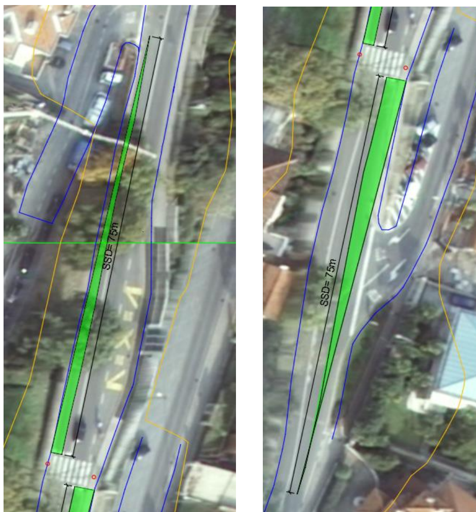
Slika 57. Grafički prikaz zaustavne preglednosti za pješački prijelaz 10 [14]
