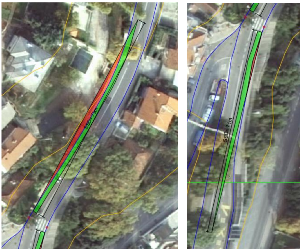
Slika 56. Grafički prikaz zaustavne preglednosti za pješački prijelaz 9 [14]
