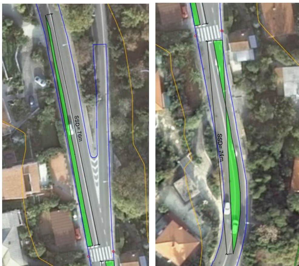
Slika 51. Grafički prikaz zaustavne preglednosti za pješački prijelaz 4 [14]
