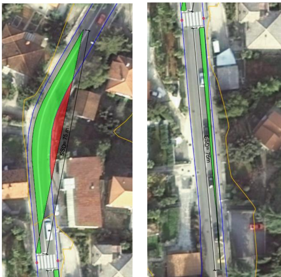
Slika 52. Grafički prikaz zaustavne preglednosti za pješački prijelaz 5 [14]
