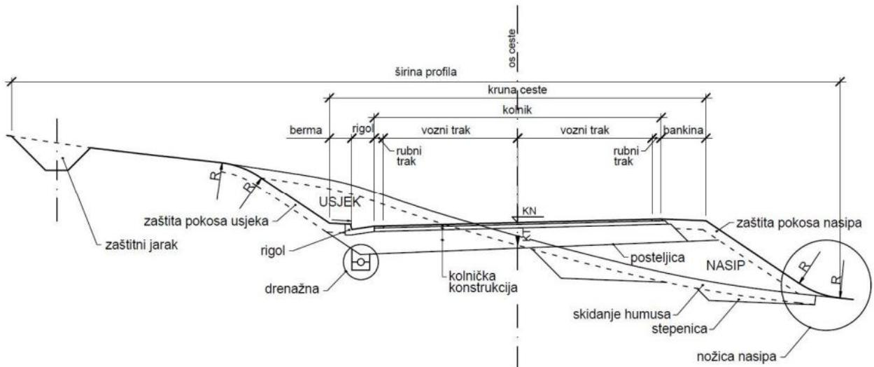
Slika 8. Elementi poprečnog presjeka [6]
