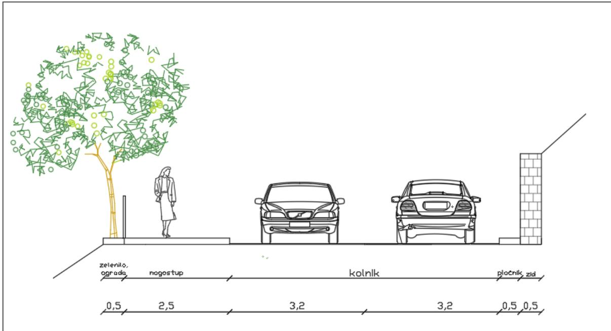
Slika 24. Poprečni profil Ul. Nove ceste [14]
