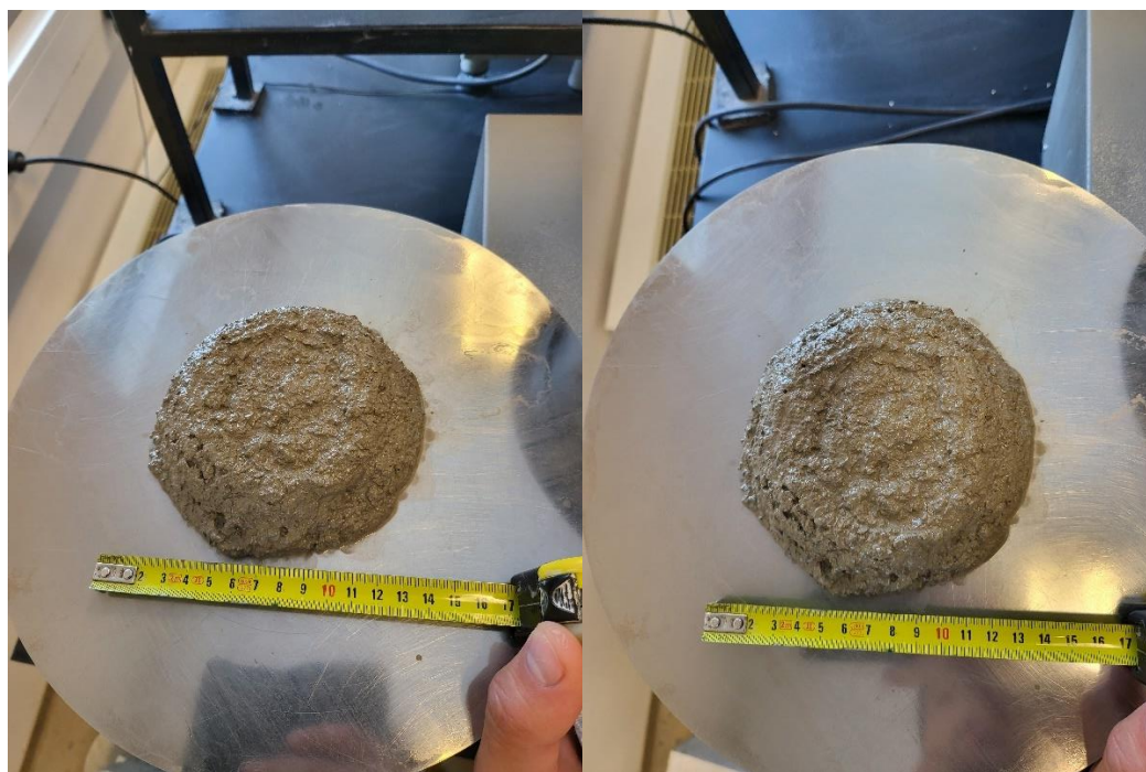
Slika 17. Rasprostiranje cementne mješavine CM5%
