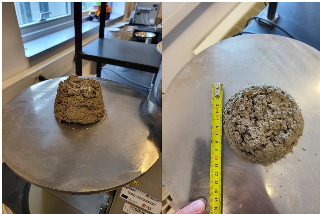
Slika 19. Rasprostiranje cementne mješavine CM15%
