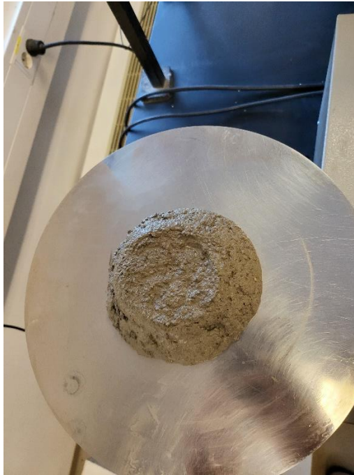
Slika 18. Rasprostiranje cementne mješavine CM10%
