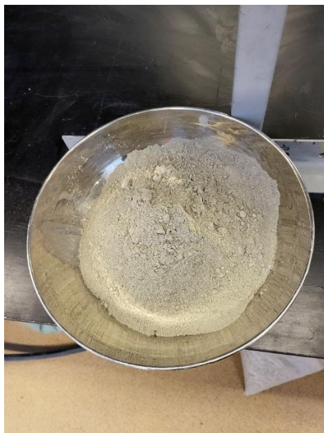
Slika 2. Prosijavanje uzorka cementnog otpadnog mulja
