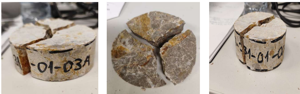
Slika 28: Uzorci ispitivani aksijalnim testom nakon loma
