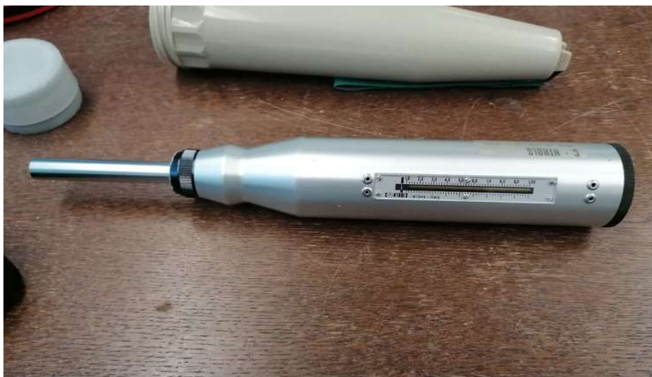
Slika 19: Schmidov čekić iz Laboratorija za geotehniku Građevinskog fakulteta u Rijeci
