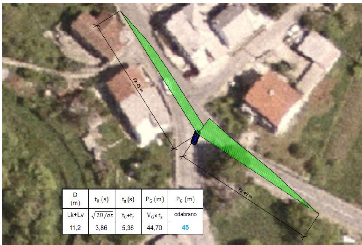
Slika 36. Raskrižje Drenova sa proračunom duljine preglednosti
