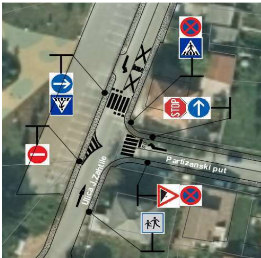
Slika 31. Prometna signalizacija na raskrižju 3
