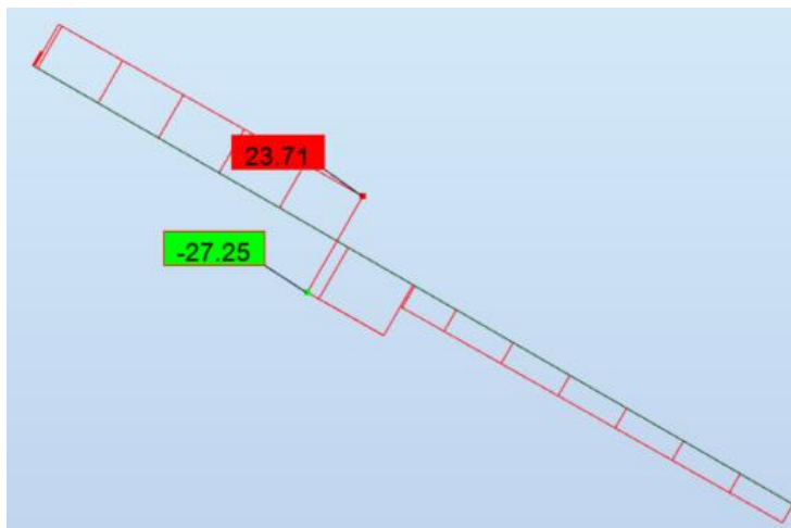
Slika 32. Vrijednosti poprečnih sila V_z desne kose prečke za kombinaciju 113.
