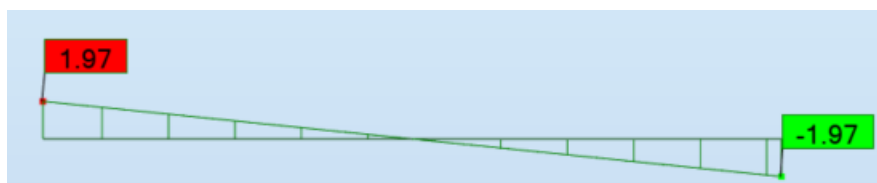
Slika 28. Vrijednost poprečne sile V_y podrožnice. Za kombinaciju 113
