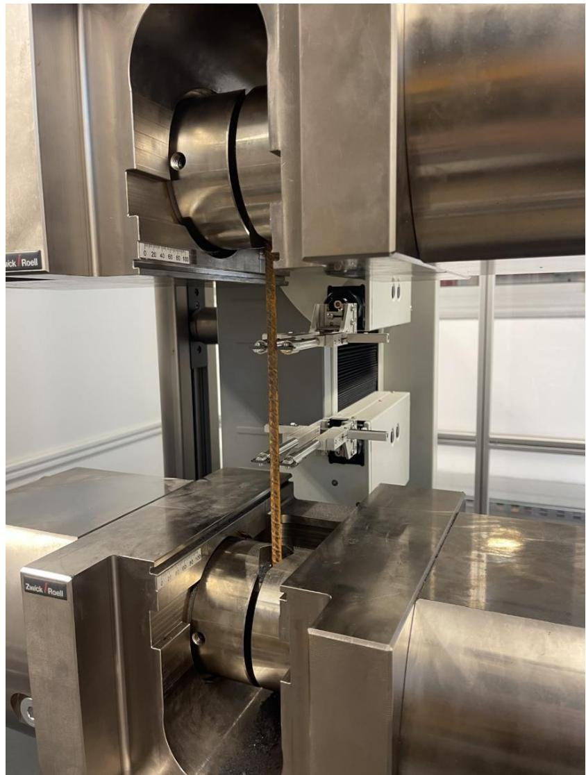
*Slika 11 Hidraulična čeljust sa uzorkom neposredno prije ispitivanja*
