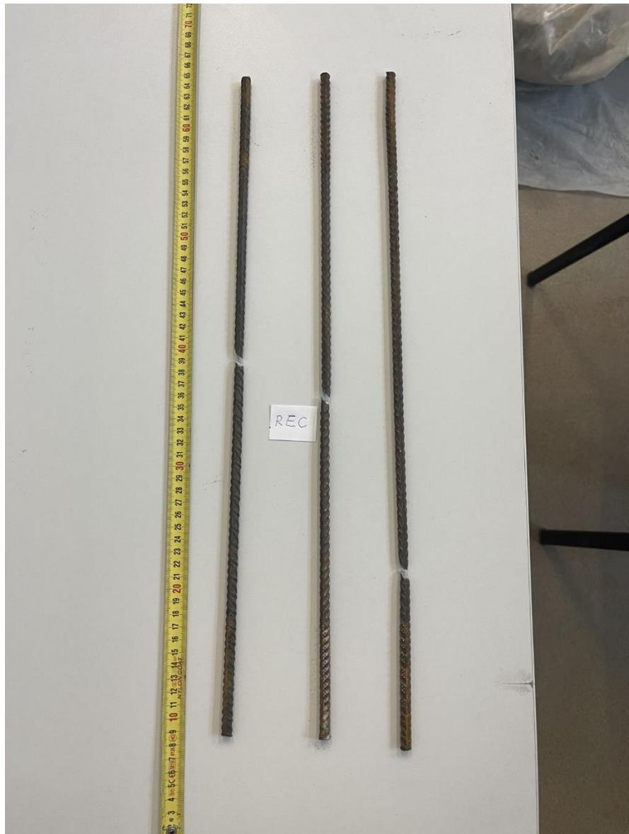
Slika 20 Uzorci nakon vlačnog ispitivanja na preporučenim brzinama
