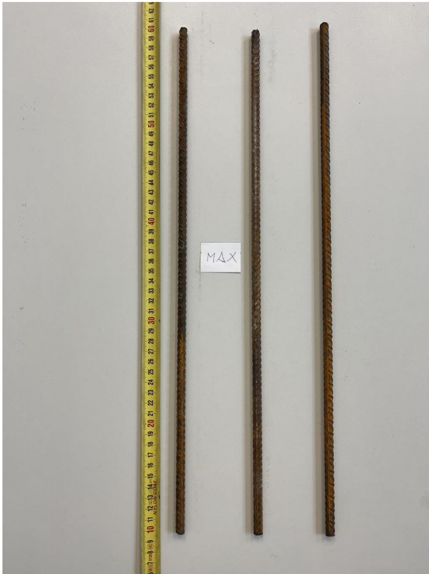
Slika 26 Uzorci nakon vlačnog ispitivanja na maksimalnim brzinama
