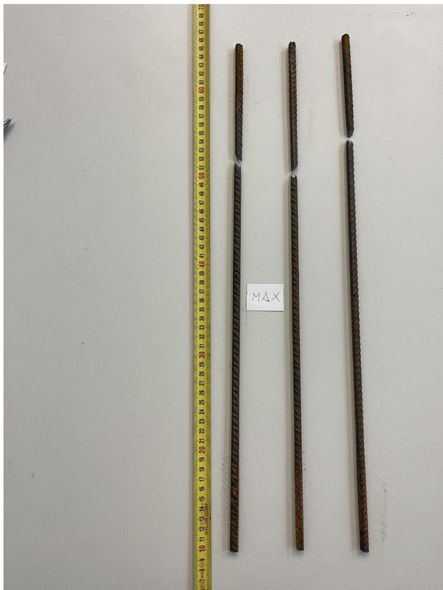
Slika 27 Uzorci nakon vlačnog ispitivanja na maksimalnim brzinama
