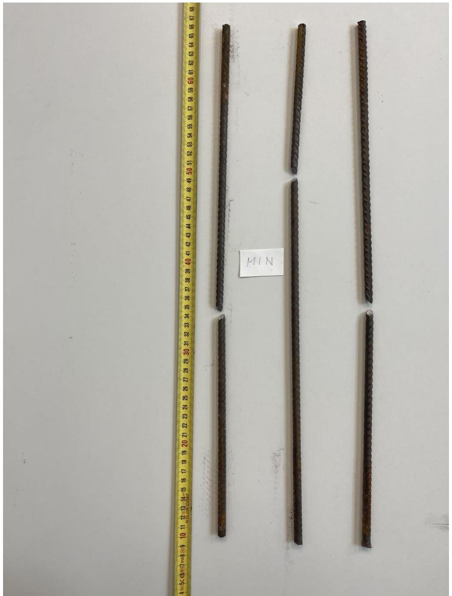
Slika 34 Uzorci nakon vlačnog ispitivanja na minimalnim brzinama
