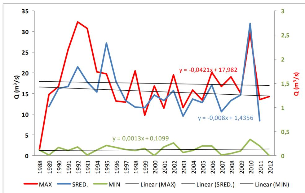
Slika 13: Karakteristični protoci na preljevu hidrološke postaje Bulaž [4]
