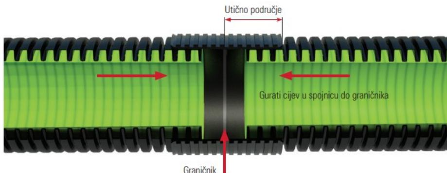
Slika 13. Presjek Vargokor PEHD cijevi i spajanje spojnicom [4]
