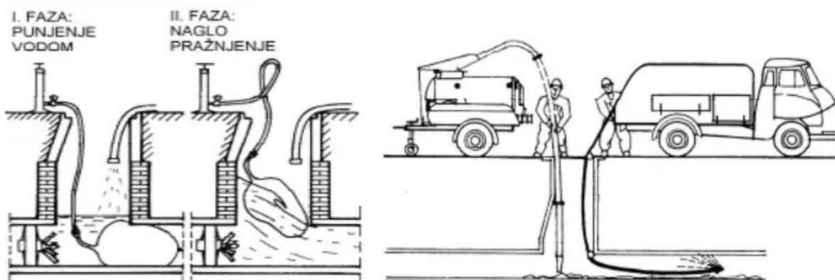
Slika 29. Ispiranje kanala vodnim valom i mlaznicom [3]
