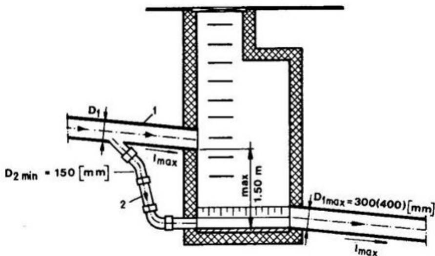
Slika 23. Okno za prekid pada sa obilaznim tunelom [3]
