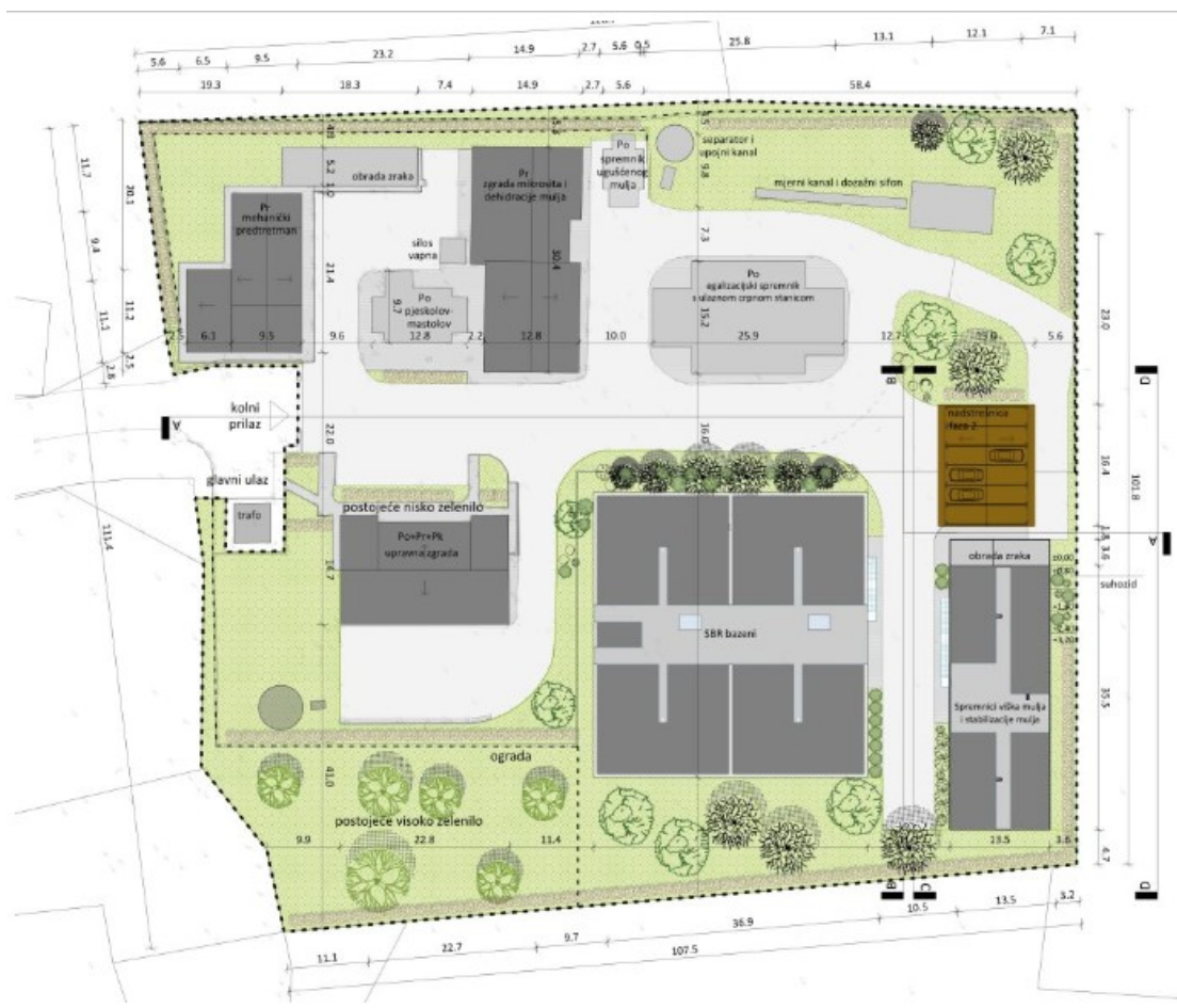
Slika 16. Tlocrtni prikaz postrojenja za pročišćavanje otpadnih voda [6]
