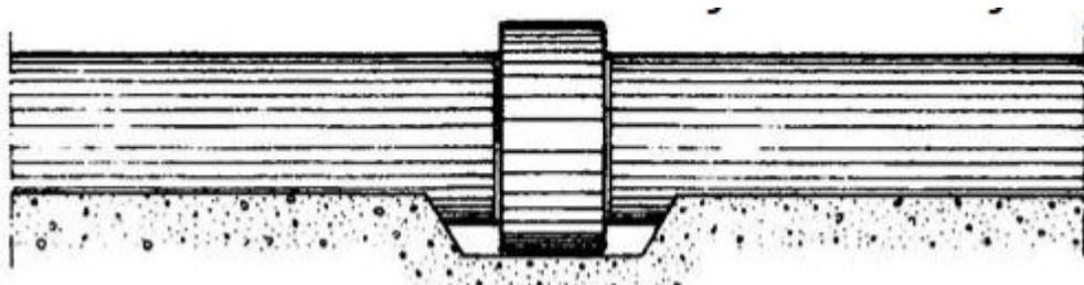
Slika 11. Polaganje cijevi u rovu u području spoja [3]
