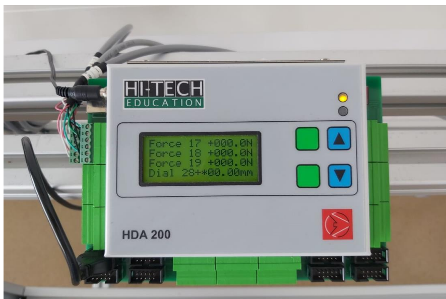
Slika 12: Uređaj za očitavanje reakcija u osloncima
