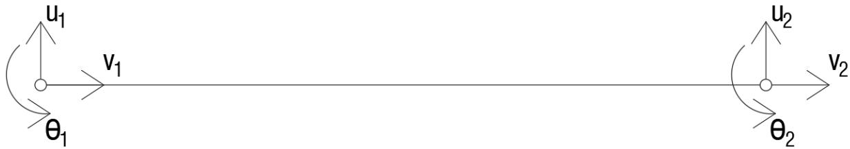
Slika 10. Dvodimenzionalni nosač sa dva čvora
