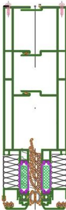
Slika 3. Horizontalni poprečni presjek vertikalnih profila fasadnog elementa
