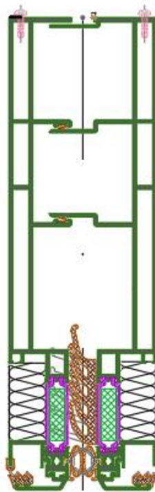
Slika 3. Horizontalni poprečni presjek vertikalnih profila fasadnog elementa
