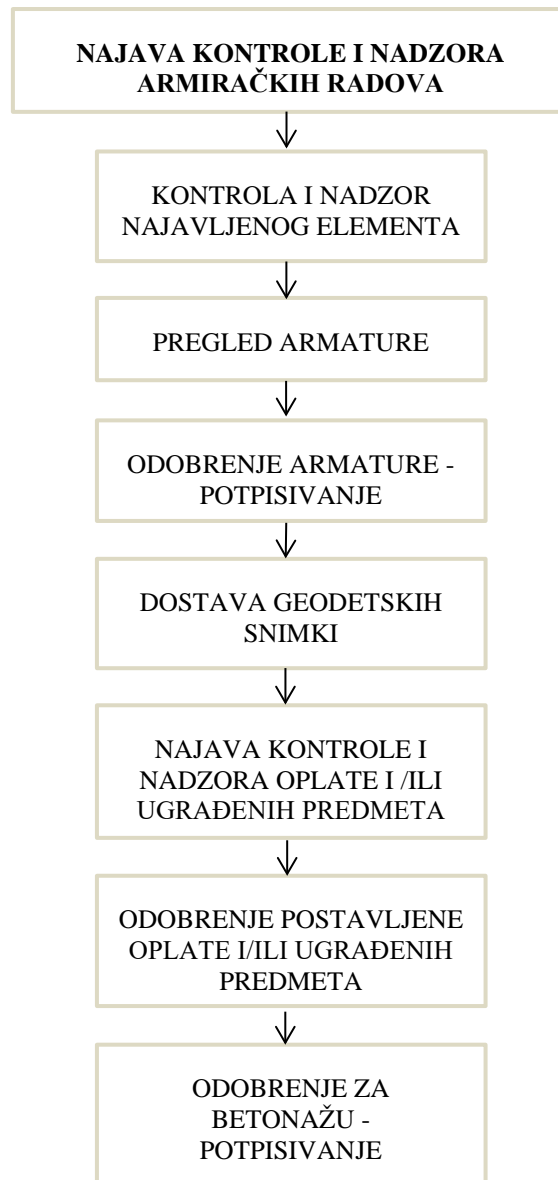
Slika 27. Prikaz dijagrama toka kontrole i nadzora armiračkih radova (autor)
