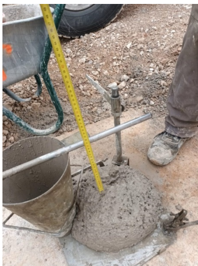
Slika 28. Primjer mjerenja konzistencije svježeg betona (autor)
