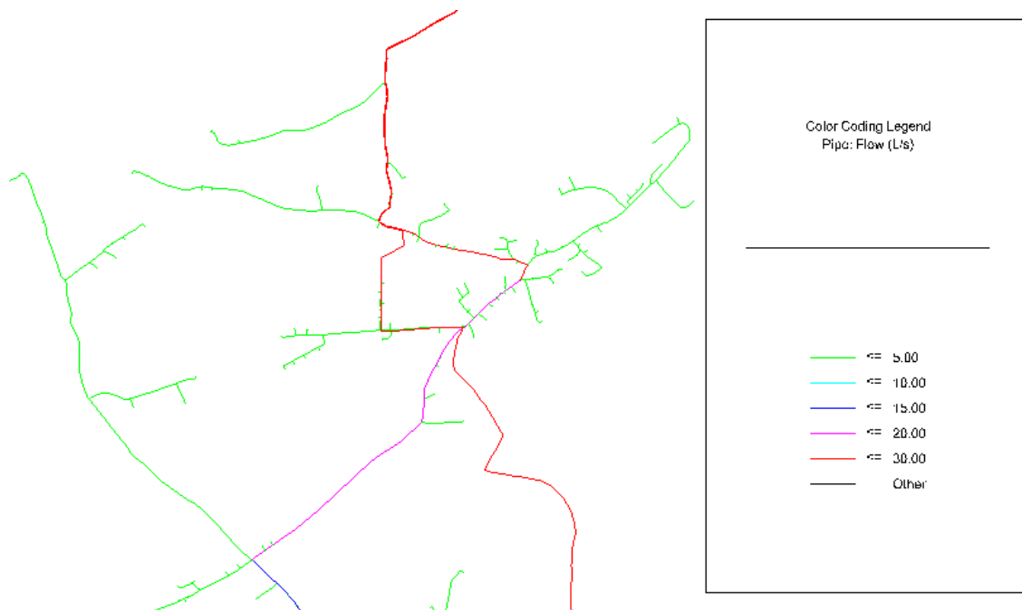
Slika 59: Prikaz promjene protoka pomoću “Color Coding” opcije, a) - za vrijeme potrošnje vode upola manje od maksimalne satne potrošnje vode (20 h), b) – za vrijeme maksimalne satne potrošnje vode (7 h)
