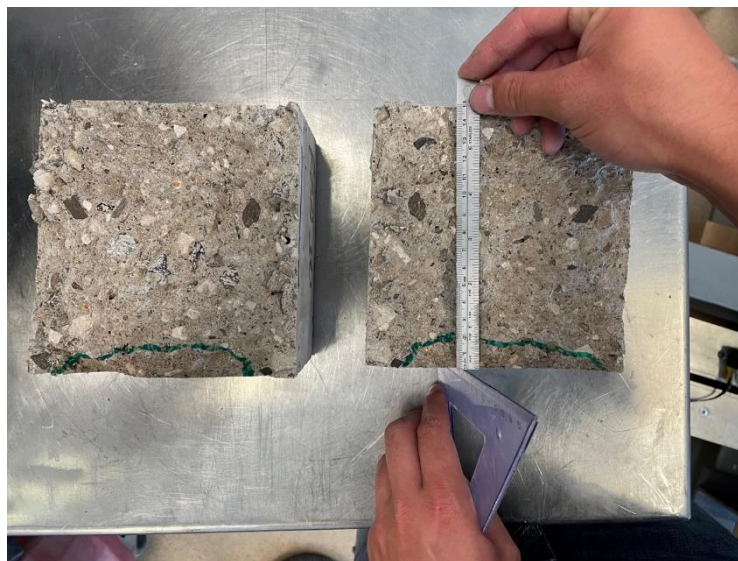
Slika 16: Označavanje i mjerenje dubine prodora vode (Autor: Matija Budić)
