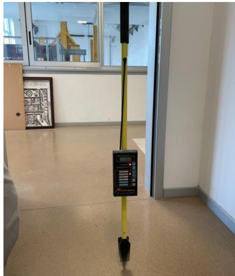
Slika 28: Instrument za ispitivanje vlažnosti agregata (Autor: Matija Budić)
