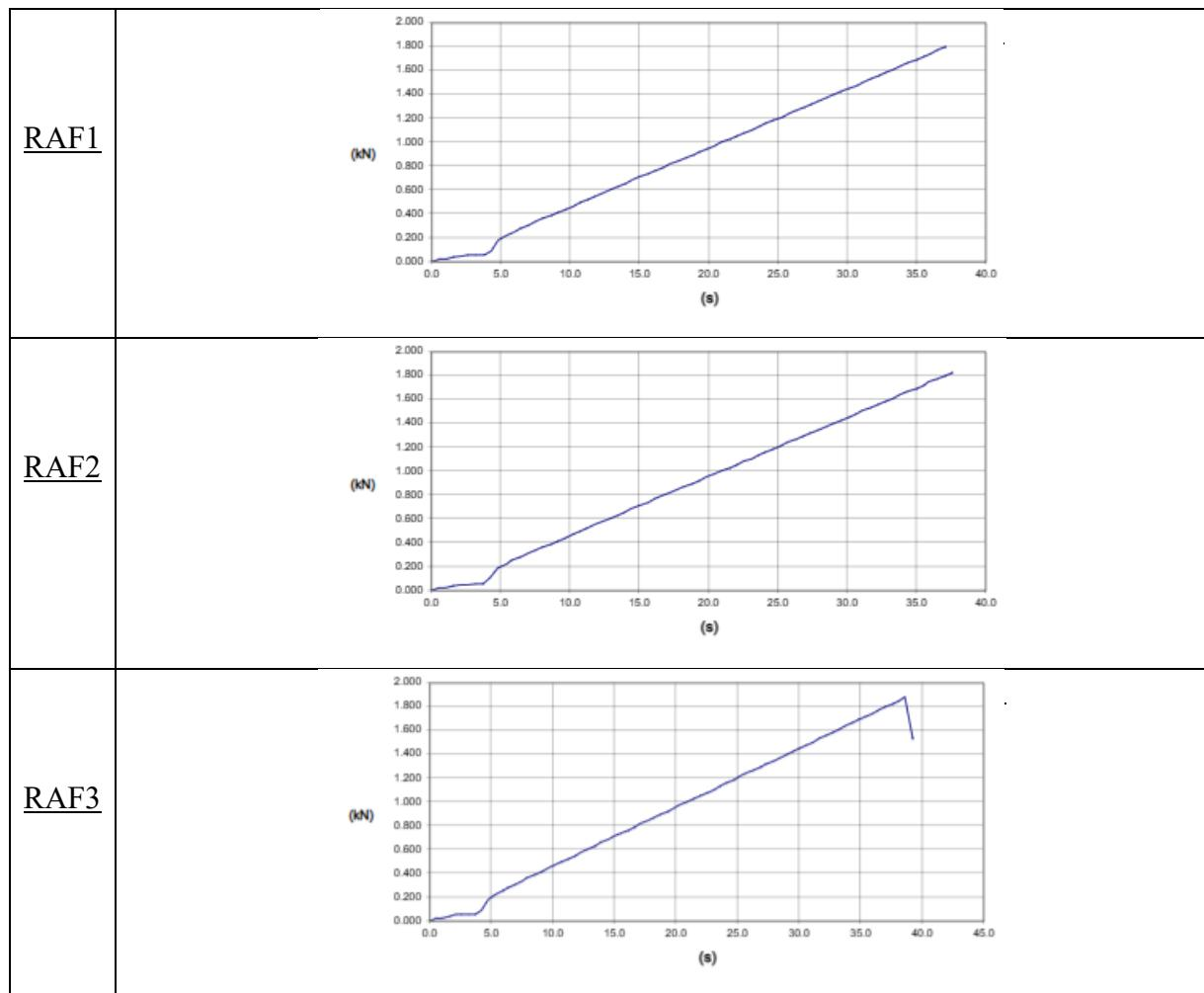
*Slika 27. Grafički prikaz nanošenja vlačnog opterećenja na uzorak s reciklranim asfaltom u vremenu, do sile sloma*
