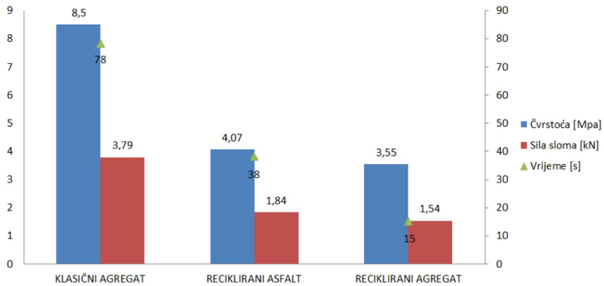
Slika 29. Grafički prikaz usporedbe uzoraka po prosječnoj čvrstoći, sili sloma i vremenu do trenutka sloma, ispitivanje na vlast
