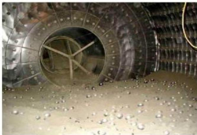
*Slika 4. Mljevenje klinkera, unutrašnjost mlina s kuglama [1]*
