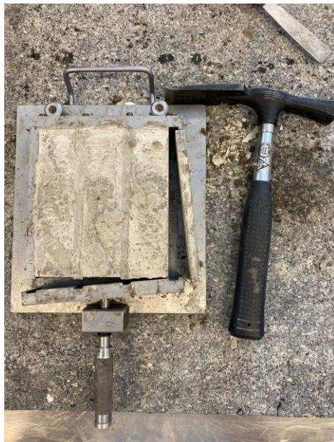
Slika 20. Odvajanje kalupa od cementnih prizmi
