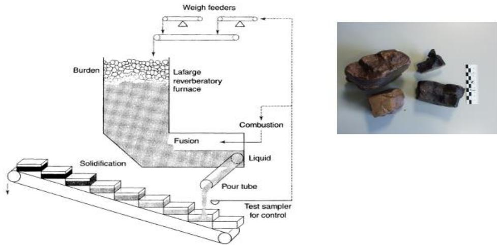
Slika 7. Proces proizvodnje cementa u verikalnoj peći (lijevo), klinker dobiven taljenjem (desno) [1]
