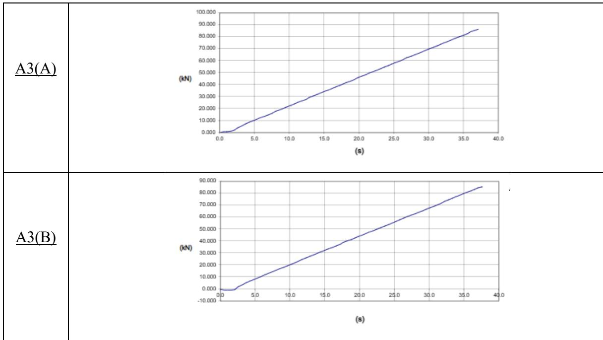
*Slika 32. Grafički prikaz nanošenja tlačnog opterećenja na uzorak s klasičnim agregatom u vremenu, do sile sloma*
