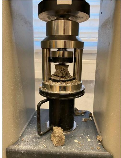
Slika 31. Oblik sloma uzorka, nakon spitivanja na tlak
