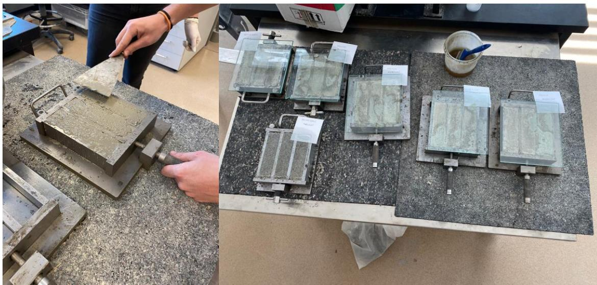
Slika 19. Cementni mort u kalupima
