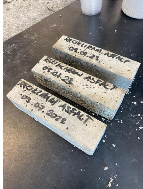
Slika 23. Prizme s agregatom od recikliranog asfalta
