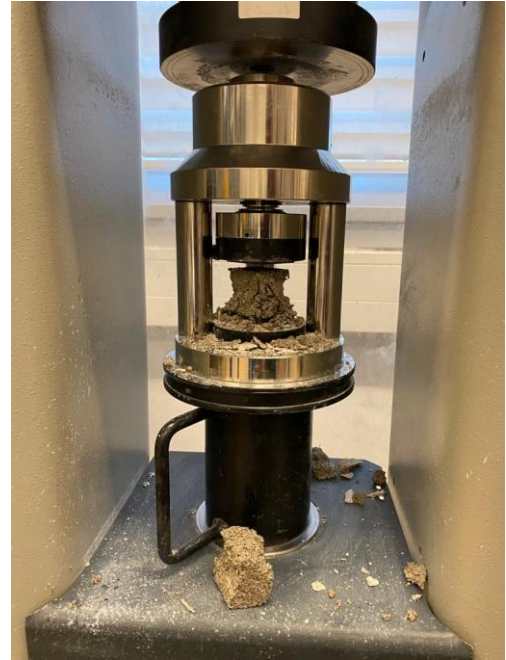
Slika 31. Oblik sloma uzorka, nakon spitivanja na tlak
