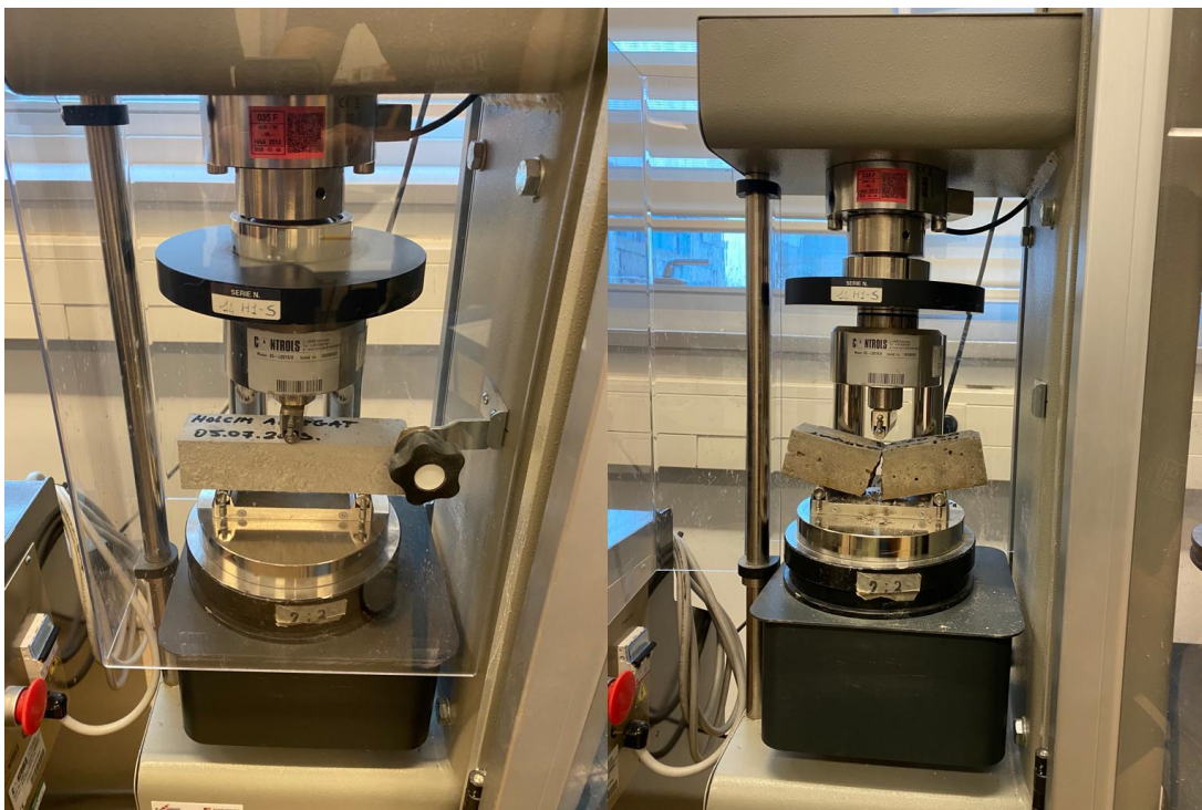
Slika 25. Ispitivanje vlačne čvrstoće savijanjem
