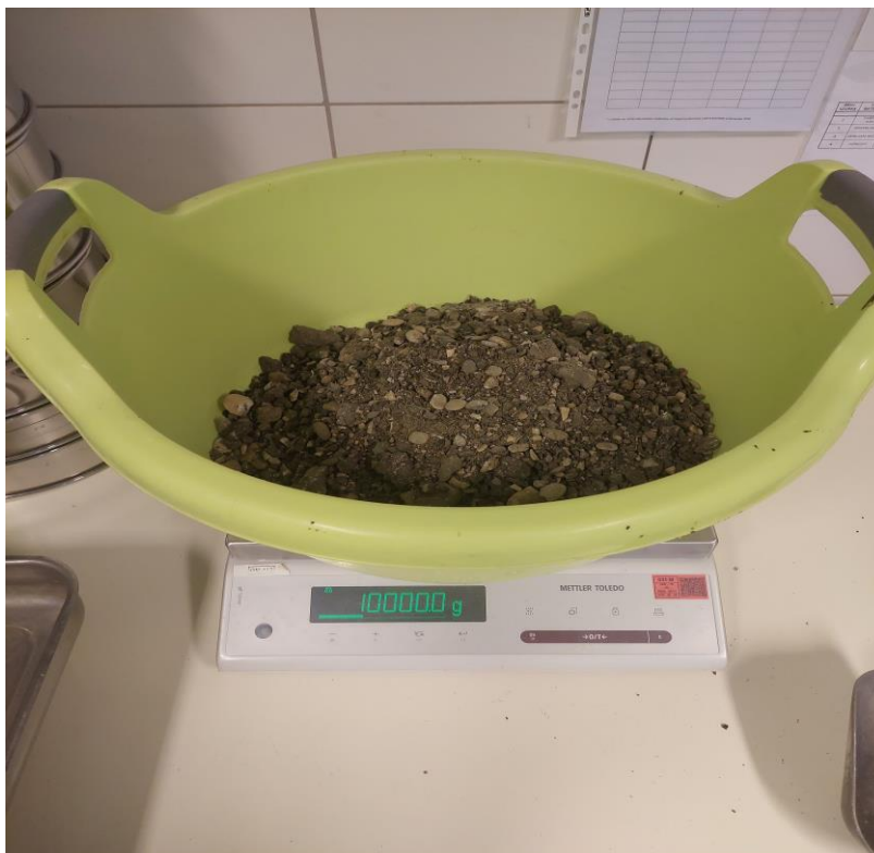
Slika 9: Asfaltni materijal postojeće konstrukcije nakon glodanja
