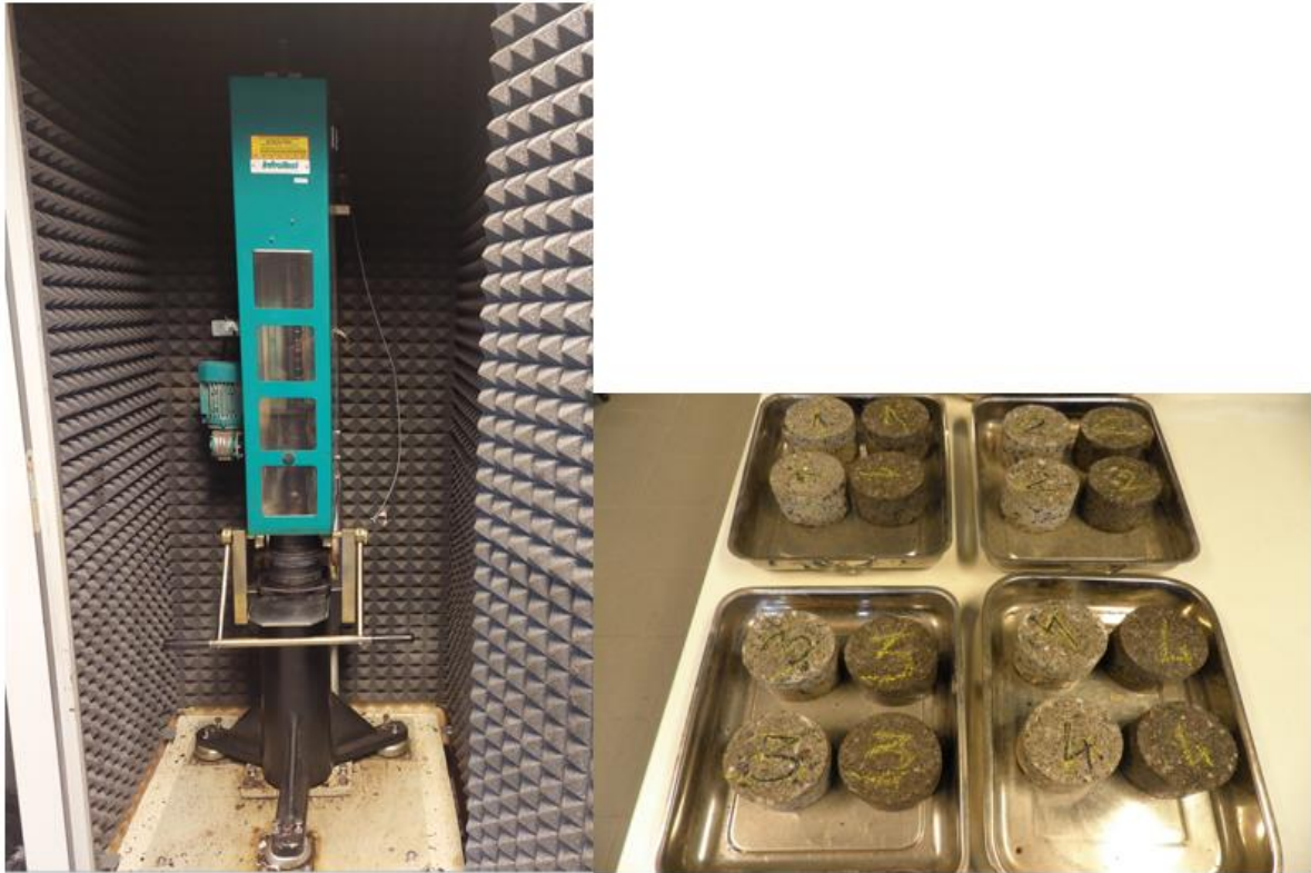
Slika 5: Priprema laboratorijskog probnog uzorka Marshall nabijačem sa pripremljenim uzorcima
