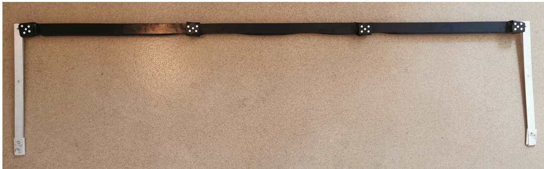
Slika 5.3: Fizikalni model okvira sa stupovima manje krutosti
