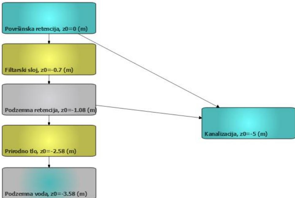
Slika 16: Primjer modeliranja kišnog vrta u GIFTModu prema prethodnoj shemi (prikaz konceptualnog modela iz GIFTMod računalnog programa)
