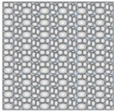
Slika 18: Blok saturiranog tla (prema [19])
