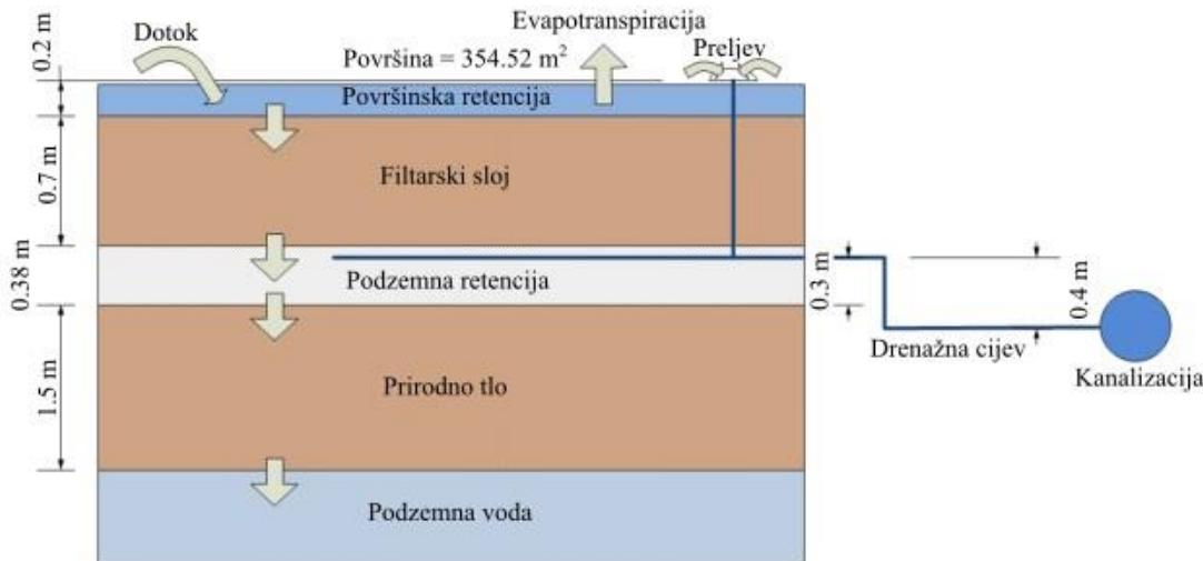
Slika 15: Primjer sheme kišnog vrta (modificirano prema [19])
