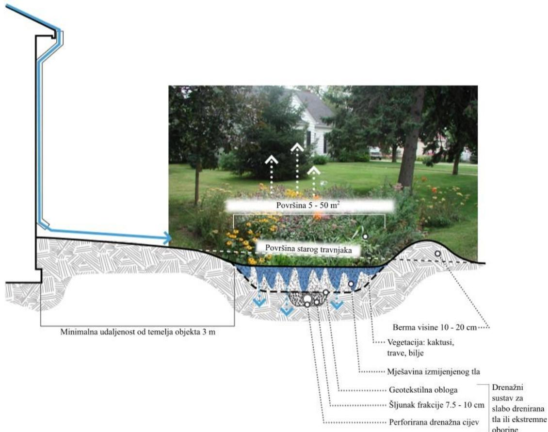
Slika 10: Shematski prikaz klasičnog kišnog vrta (modificirano prema [4])
