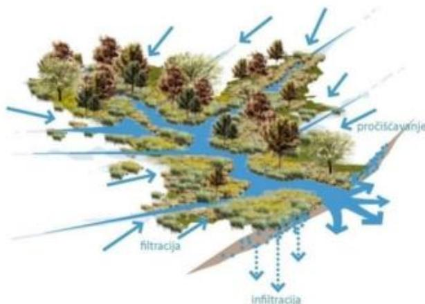
Slika 5: Integralni pristup odvodnje oborinske vode [4]
