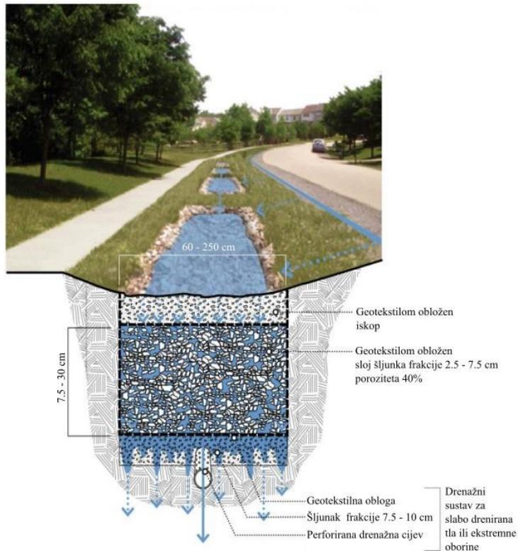
Slika 8: Shematski prikaz infiltracijskog jarka (modificirano prema [4])
