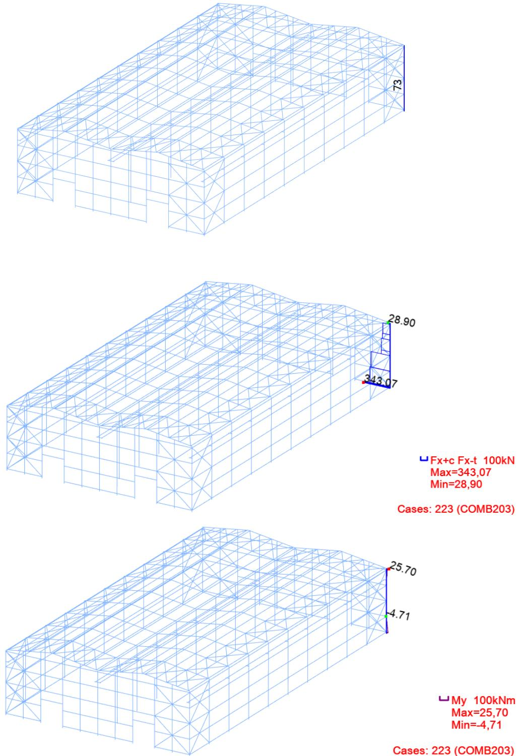
Slika 40. Položaj i vrijednosti dijagrama na vanjskom zabatnom stupu mjerodavnom za dimenzioniranje [izradio autor]
