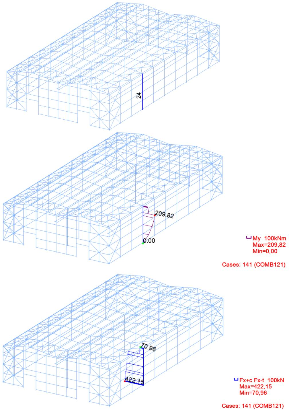
Slika 39. Položaj i vrijednosti dijagrama na vanjskom stupu mjerodavnom za dimenzioniranje
