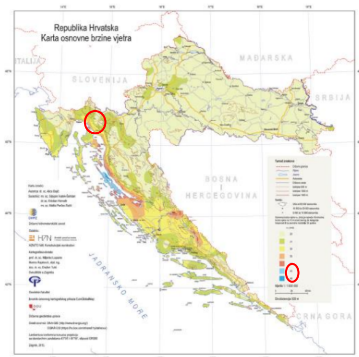
Slika 9. Osnovna brzina vjetra V_{b,0} (HRN EN 1991-1-4:2010) (Državni hidrometeorološki zavod) [8]
