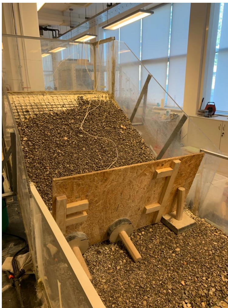
Slika 7. Ugradnja šljunka za izradu drenažnog sloja na središnjem dijelu modela.
