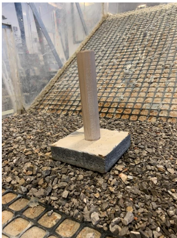
Slika 6. Ručni kompaktor korišten za zbijanje materijala.
