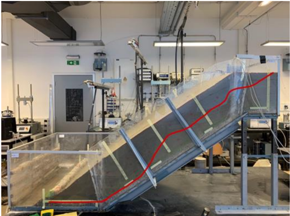
Slika 26. Prikaz prodiranja vode u materijal označen crvenom linijom.
