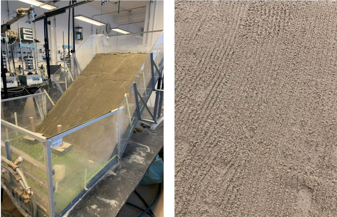
Slika 9. Prikaz ugrađenih slojeva i izrezbarene površine materijala.
