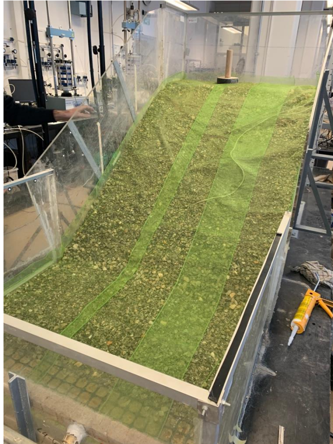
Slika 8. Geotekstil (membrana) postavljena na kontaktu slojeva.
