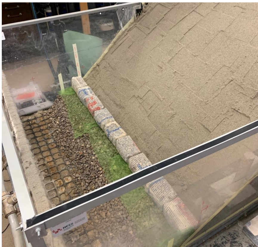
Slika 12. Prikaz završenog modela s gabionima smještenima u nožici kosine.
