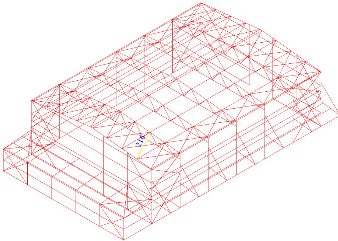
Slika 76. Krovni poprečni vjetrovni vez mjerodavan za dimenzioniranje - element 216
