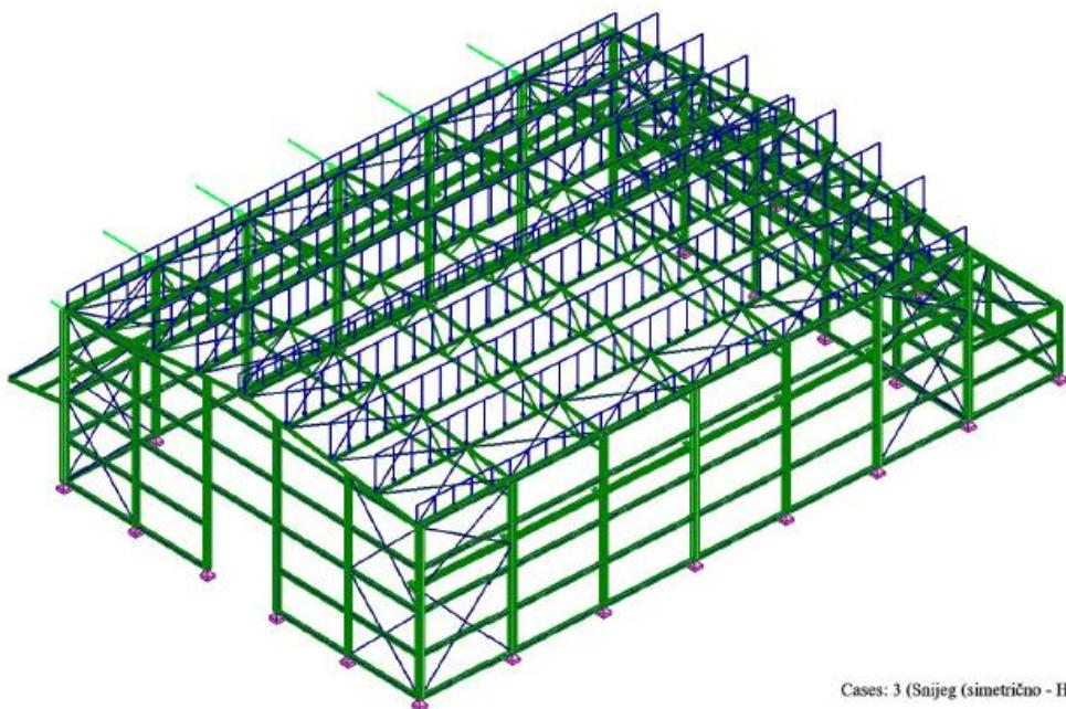
Slika 39. Prikaz djelovanja simetričnog snijega na konstrukciju (dio hale) [izradio autor]
