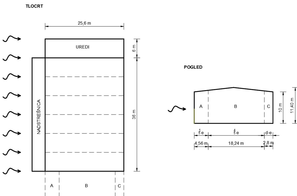
Slika 8. Tlocrt i pogled na vertikalne zidove izložene djelovanju transverzalnog vjetra ( $\theta = 0^\circ$ ).
