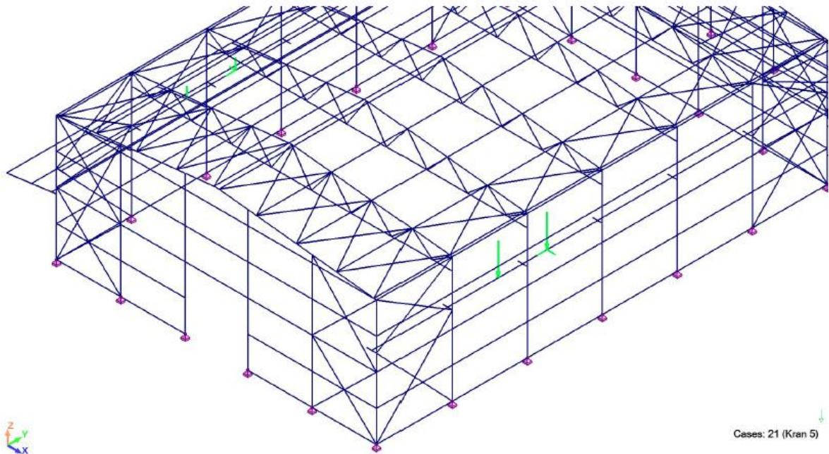
Slika 60. Položaj krana 5 – os glavnog nosača nalazi se između sila krana – maksimalne sile desno, minimalne lijevo [izradio autor]
