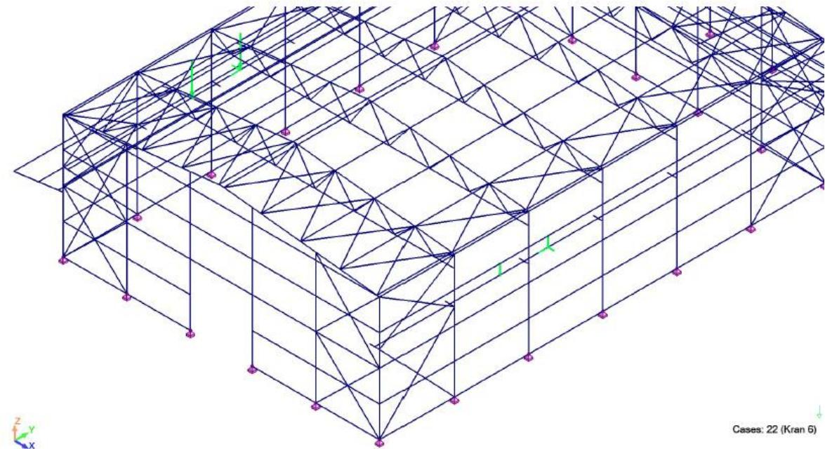
Slika 61. Položaj krana 6 – os glavnog nosača nalazi se između sila krana – minimalne sile desno, maksimalne lijevo [izradio autor]
