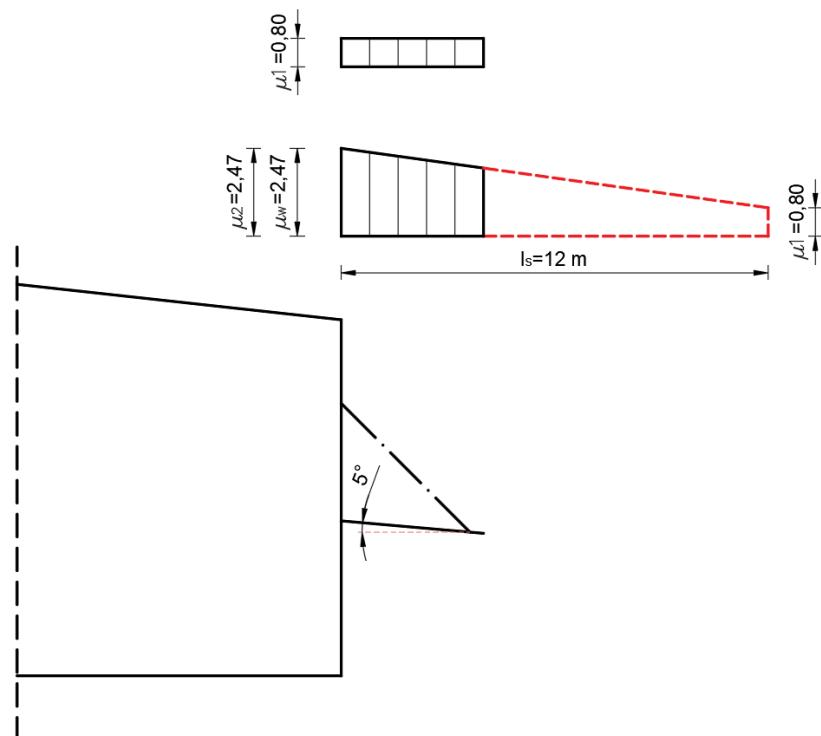
Slika 6. Slučaj opterećenja snijegom na nadstrešnicu. Modificirano prema [3]
