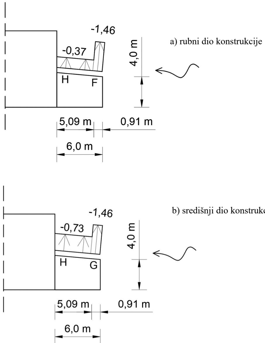
Slika 28. Prikaz opterećenja na krovnu plohu izloženih djelovanju transverzalnog vjetra ( $\theta = 0^\circ$ ) - presjeci. Modificirano prema [5]
