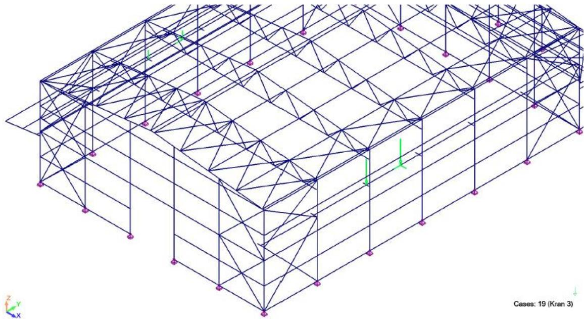
Slika 58. Položaj krana 3 – sila kotača nalazi se na osi glavnog nosača – maksimalne sile desno, minimalne lijevo [izradio autor]
