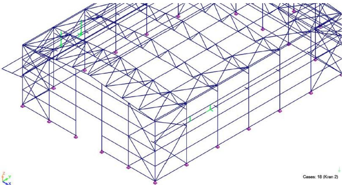
Slika 57. Položaj krana 2 – sile kotača nalaze se između dva glavna nosača – minimalne sile desno, maksimalne lijevo [izradio autor]
