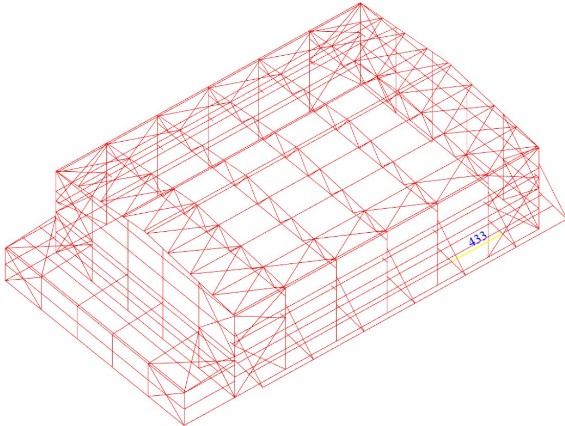
Slika 68. Položaj podrožnice na nadstrešnici mjerodavne za dimenzioniranje - element 433
