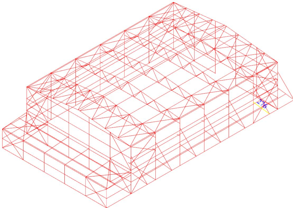
Slika 74. Položaj nosača nadstrešnice mjerodavnog za dimenzioniranje - element 276
