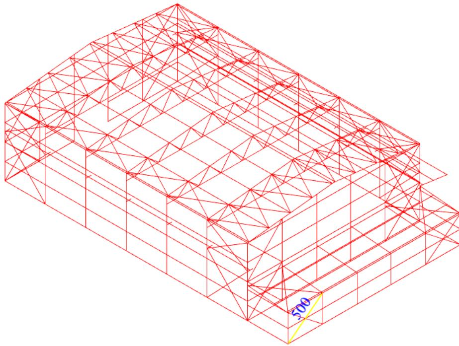
Slika 80. Položaj uredskog fasadnog vjetrovnog veza mjerodavnog za dimenzioniranje - element 500 [izradio autor]
