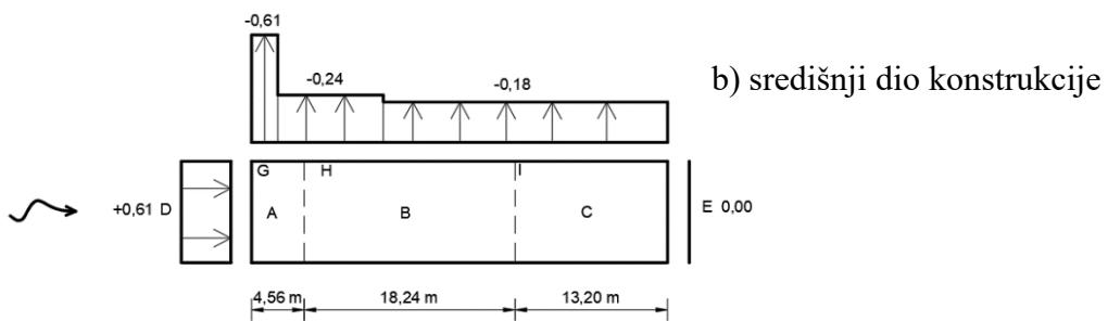
Slika 24. Prikaz opterećenja na vertikalne zidove i krovnu plohu izloženih djelovanju longitudinalnog vjetra ( $\theta = 90^\circ$ ) za Slučaj 4 – presjek. Modificirano prema [5]
