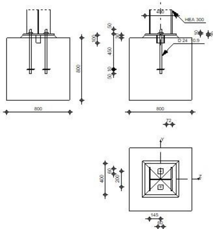
Slika 85. Prikaz spoja AB temelja i čeličnog stupa [izradio autor]
