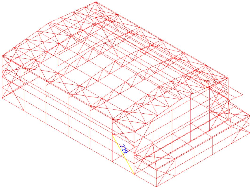
Slika 77. Fasadni uzdužni vjetrovni vez mjerodavan za dimenzioniranje - element 229
