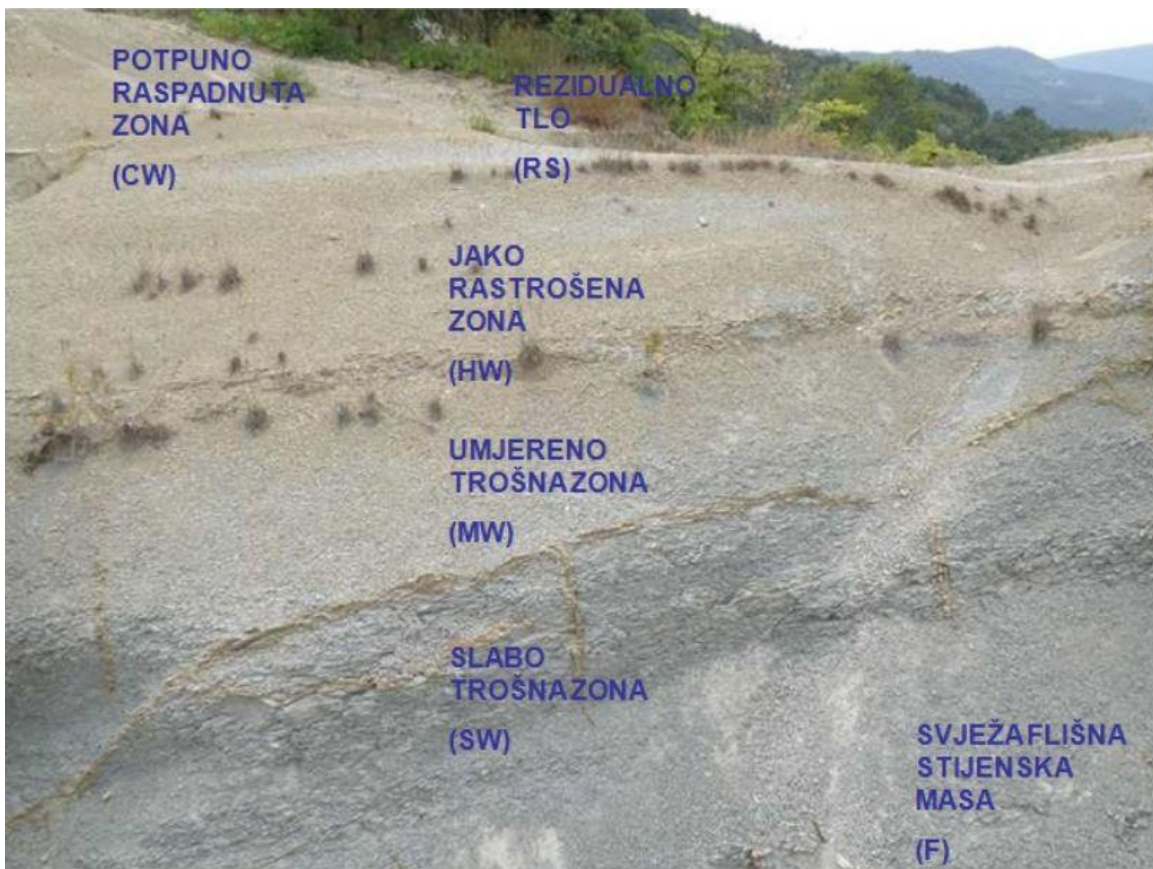
Slika 3 Stupnjevi trošenja flišne stijenske mase (preuzeto iz Dugonjić Jovančević, 2013)
