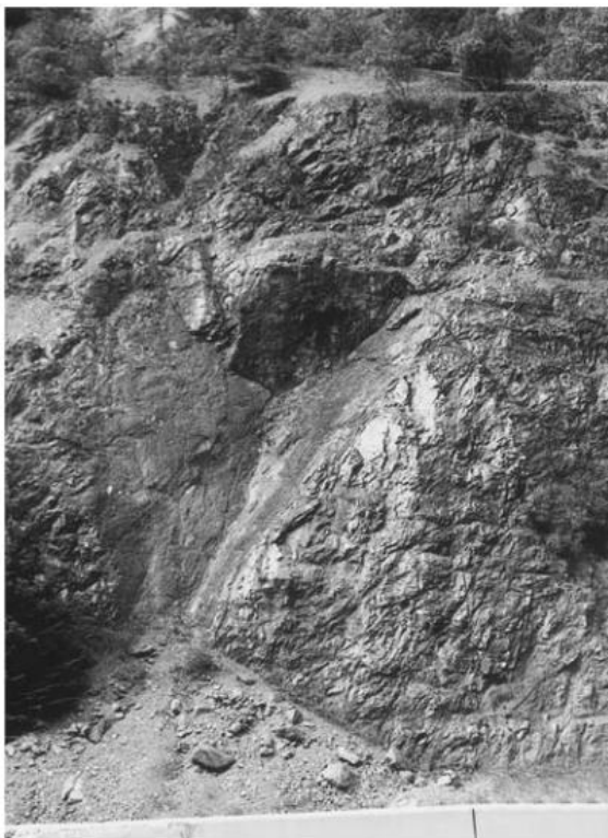
Slika 12. Tipični klinasti slom [2]
