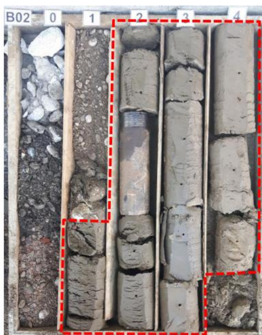
Slika 34: Log bušotine - prikaz gornjeg horizonta tvrde gline [34]
