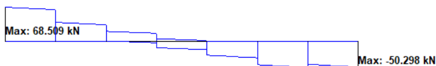
Slika 53. Proračunske vrijednosti poprečnih sila grede u Staad.Pro-u
