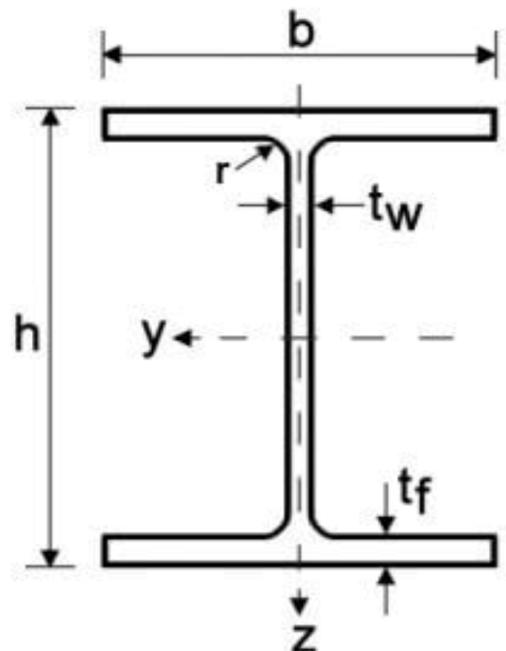
Slika 28: Poprečni presjek stupa
