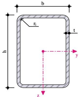
Slika 42: Poprečni presjek podrožnice
