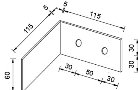
Slika 46: Nacrt spojne ploče
