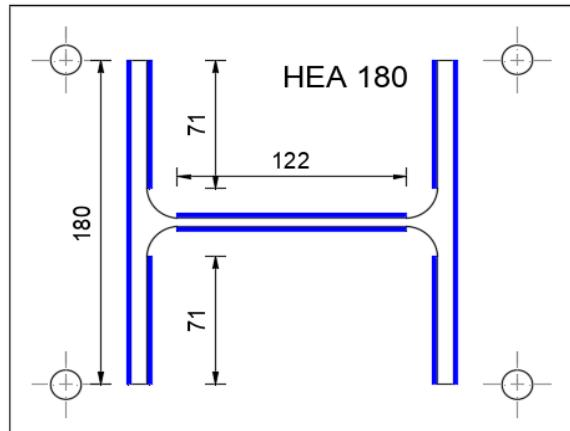
Slika 41: Nacrt pozicija zavara
