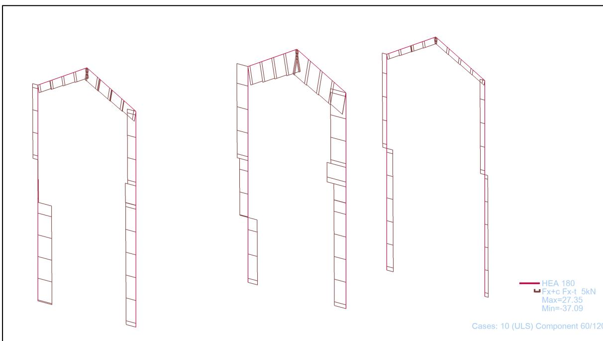
Slika 20: Dijagram uzdužnih sila na glavnoj nosivoj konstrukciji [kN]
