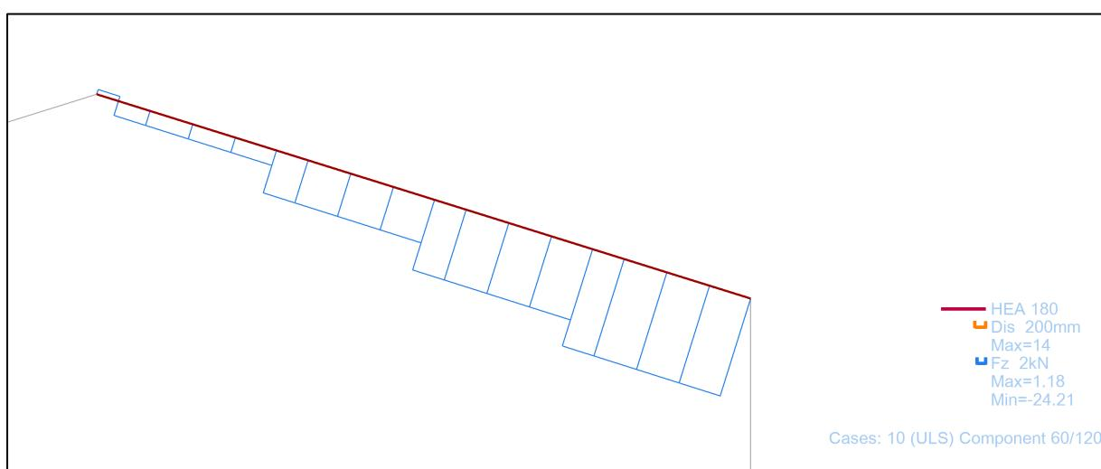
Slika 24: Dijagram poprečnih sila [kN]
