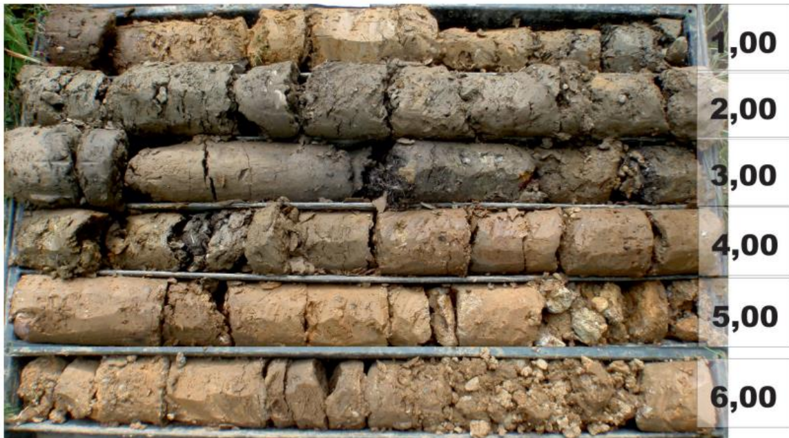
Slika 11. Jezgra bušotine B-3 (Geotehnički elaborat, 2014)
