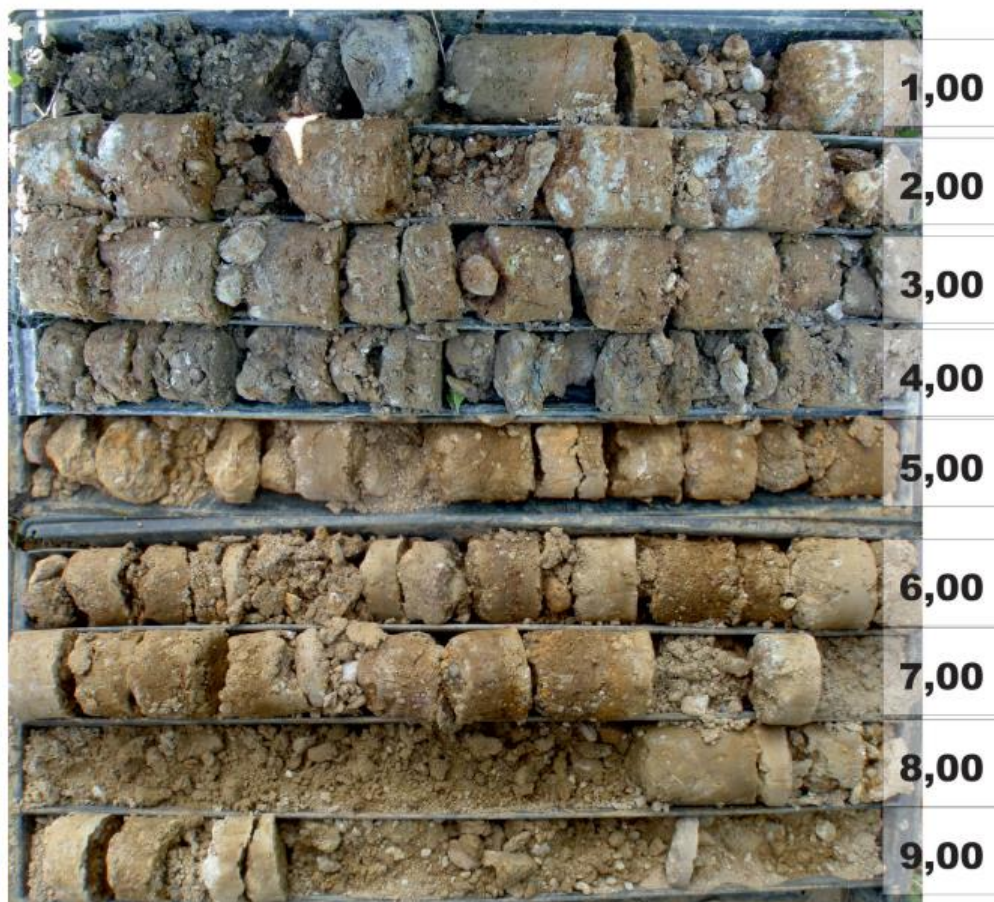
Slika 10. Jezgra bušotine B-2 (Geotehnički elaborat, 2014)
