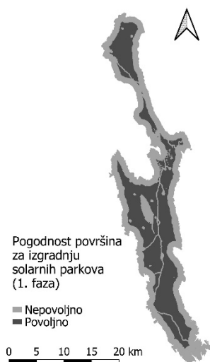
Slika 10. Rezultat 1. faze analize – izdvojene površine nepovoljne za izgradnju solarnih parkova
