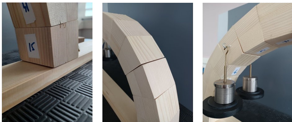
Slika 11. Detalj otvaranja zglobova pri sili F=23\text{ N} [6]
