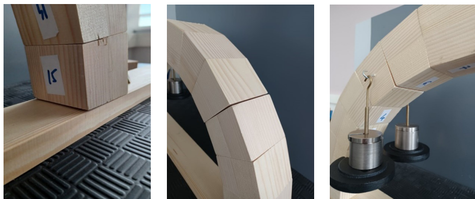
Slika 11. Detalj otvaranja zglobova pri sili F=23\text{ N} [6]
