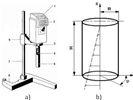
*Slika 4. a) rotacijski viskozimetar, b) princip rada [14]*
