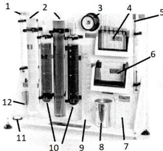
**Slika 5.** Eksperimentalni fizikalni model za ispitivanje viskoznosti [14]
