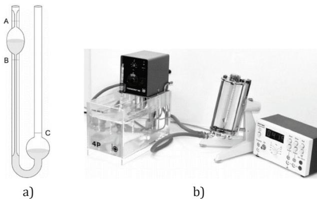
*Slika 3. a) kapilarni viskozimetar [7], b) viskozimetar s padajućom kuglicom [11]*
