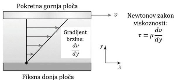
**Slika 1.** Utjecaj viskoznosti na profil brzina toka, [7]
