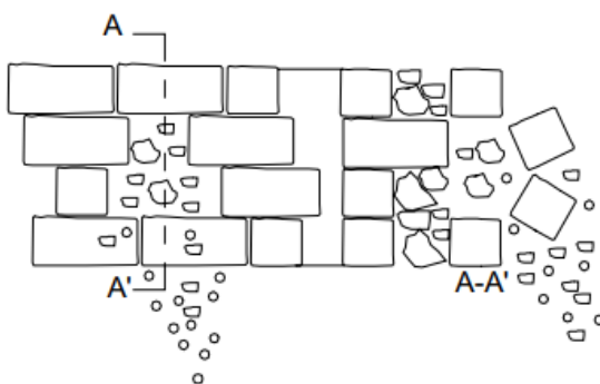
Slika 21. Lokalni slom zida: shema [2], primjer [10]
