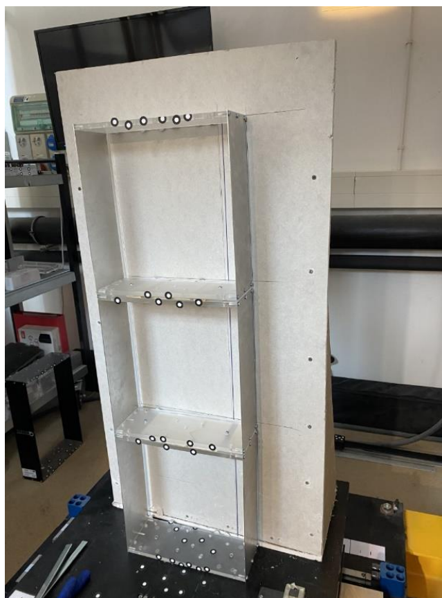
Slika 26. Uctavani pomaci na gipskartonskoj konstrukciji
