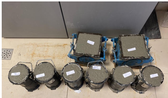
Slika 19: Izrada mješavina betona (u kalupu), (izvor: vlastita fotografija)
