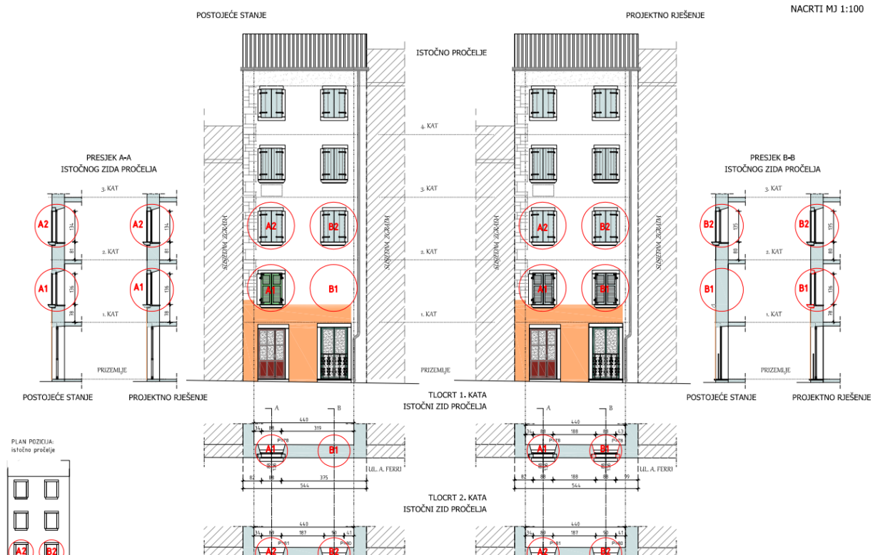
Slika 24: Primjer razrade otvaranja novog otvora (foto autorica, 2023.)
