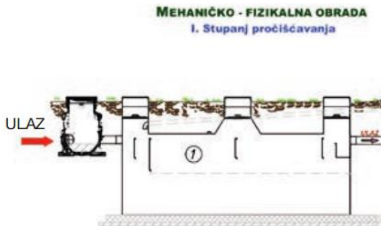
Slika 2. Mehanički predtretman (I. Stupanj pročišćavanja otpadnih voda) [7]
