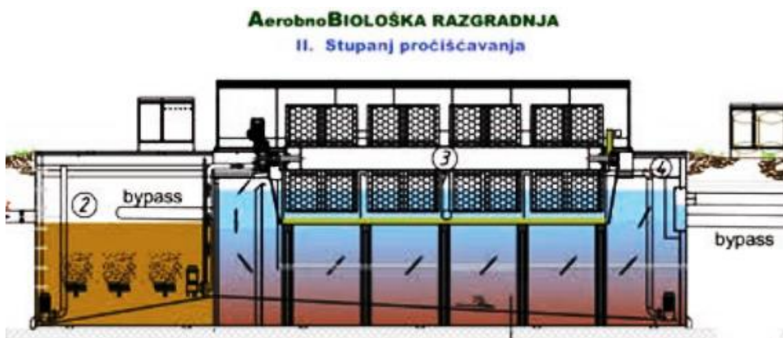
Slika 3. Biološki stupanj (II. Stupanj pročišćavanja) [7]
