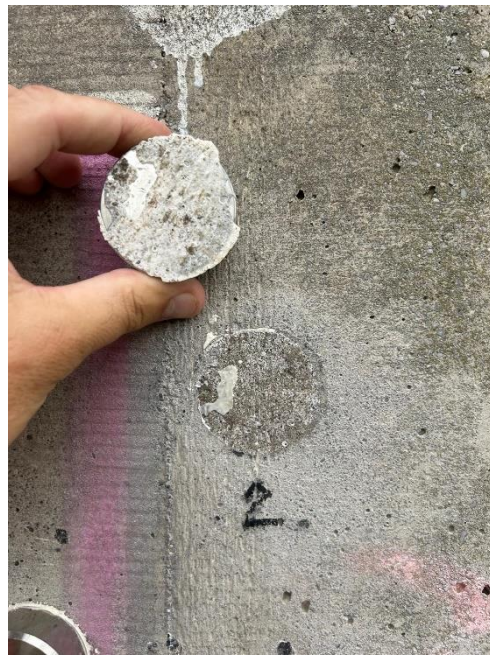
Slika 55 Prikaz sloma prilikom ispitivanja pull off metodom na poziciji B-K-1-1 (ispitni uzorak broj 2)
