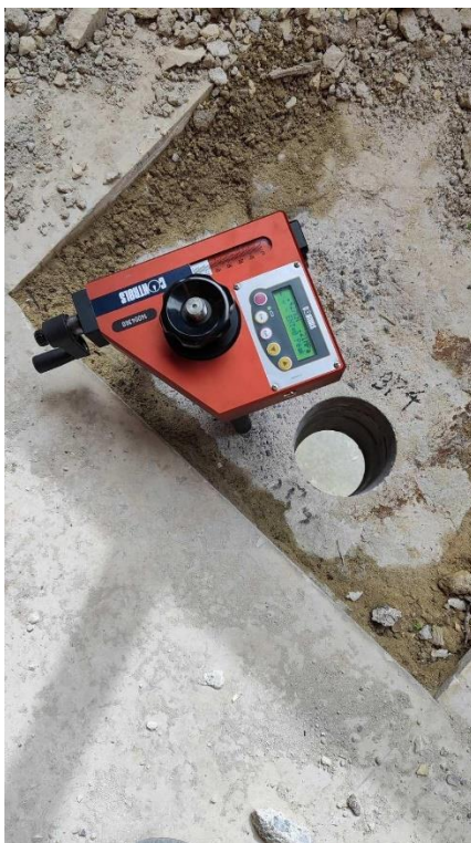
Slika 40 In situ ispitivanje pull off metodom
