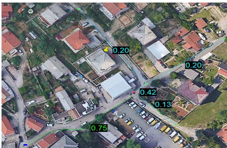
Slika 8. Protoci opskrbe količine u dionicama mreže u programu EPANET-u.
