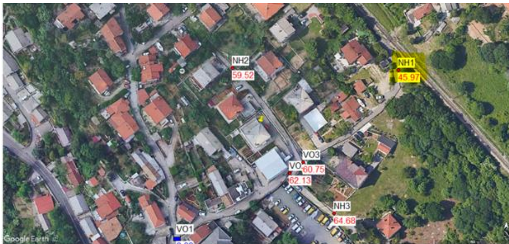
Slika 12. Piezometarske visine u mreži za vrijeme simulacije požara u blizini hidranta NH1.
