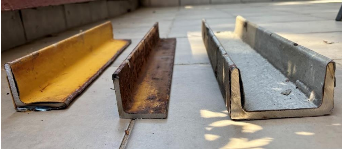
Slika 13: Elementi od kojih će biti napravljeni ispitni uzorci
