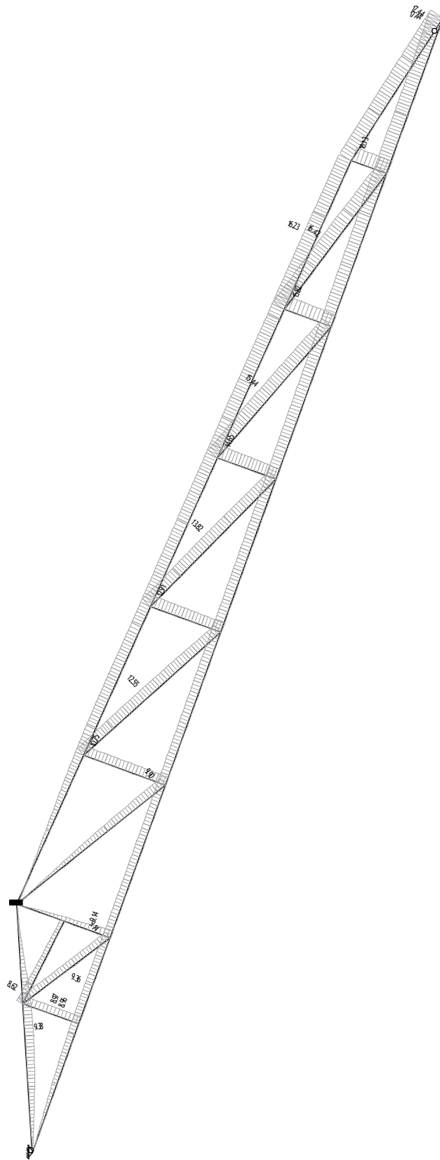
Slika 77: Dijagrami pomaka u y smjeru za tlačni nosač - bočni pojas
