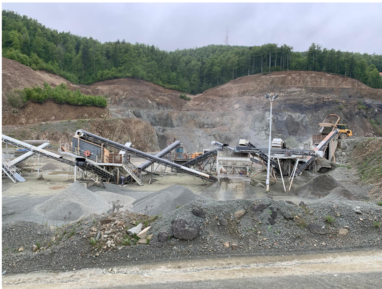
Slika 14: Drobljenje i sijanje agregata (fotografirao autor)
