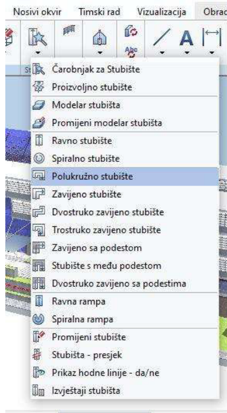
Slika 44: Izbornik s naredbama za stube (foto autor)
