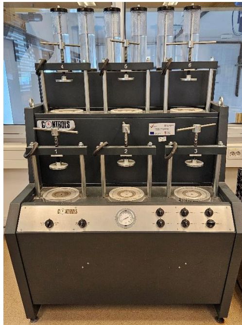
Slika 30: Uređaj za ispitivanje vodopropusnosti metodom mjerenja dubine prodora vode (Autor: Nikolina Edjut)
