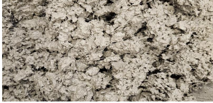
Slika 11: Betonska mješavina s polipropilenski vlaknima (Autor: Nikolina Edjut)
