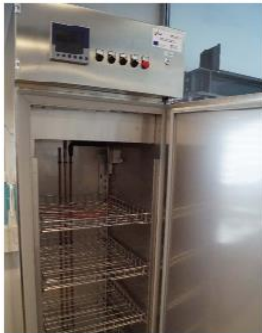
Slika 5: Komora za sušenje uzoraka [3]
