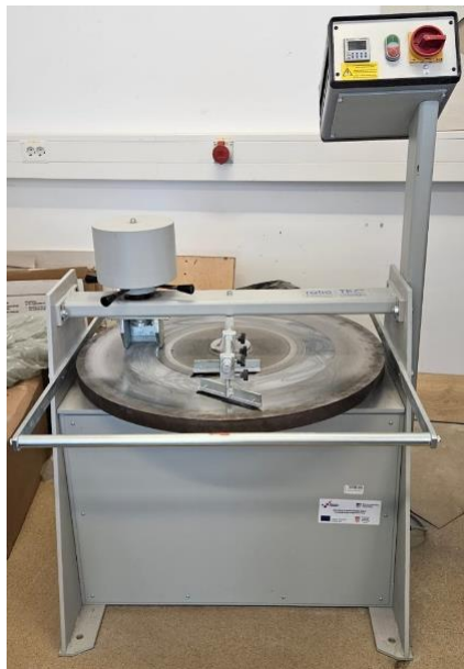
Slika 16.: Uređaj za ispitivanje habanja Bohme metodom (Autor: Nikolina Edjut)
