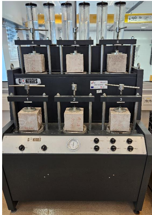
Slika 31: Uzorci opterećeni u uređaju za ispitivanje vodopropusnosti (Autor: Nikolina Edjut)
