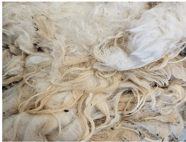
Slika 8: Vunena vlakna sa malom količinom nečistoće (Autor: Nikolina Edjut)
