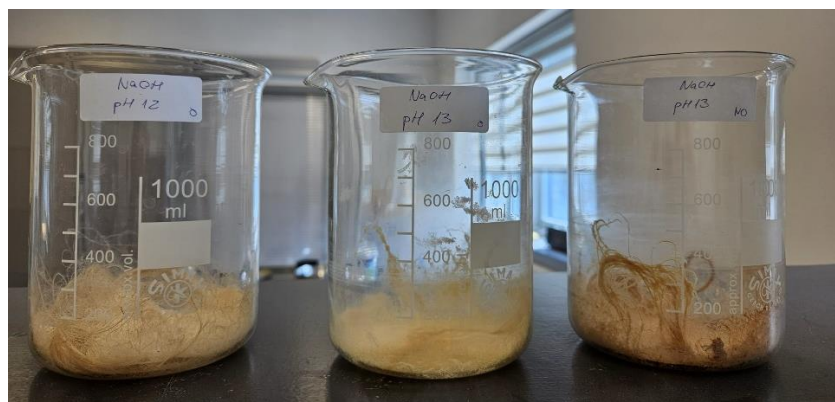
Slika 43: Vunena vlakana NaOH nakon 56 dana (Autor: Nikolina Edjut)
