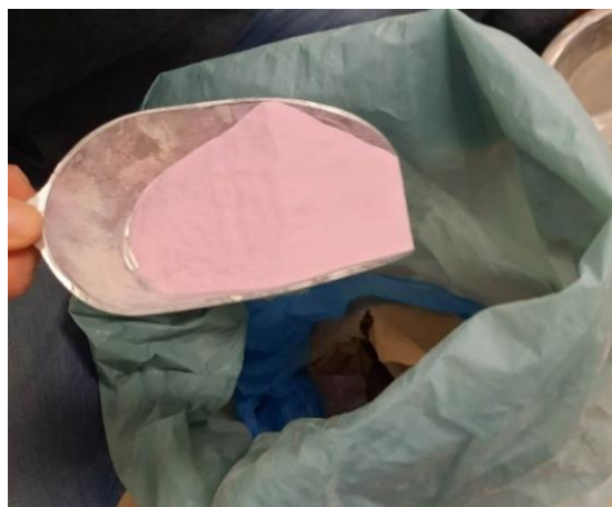
Slika 17: Brusni prah - aluminijev oksid (Autor: Nikolina Edjut)
