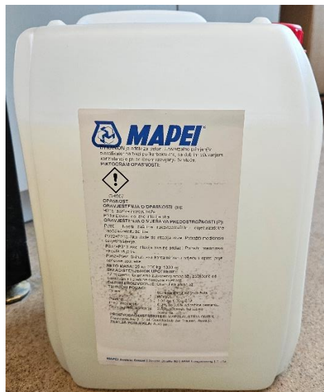
Slika 10: Superplastifikator korišten u pripremanjima betonskih mješavina (Autor: Nikolina Edjut)
