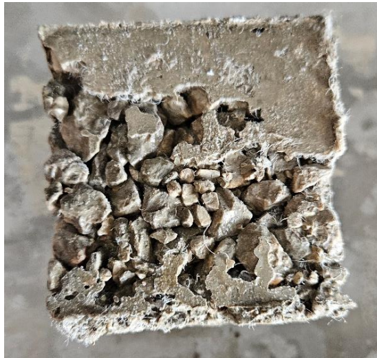
Slika 3.: Poroznost betonske mješavine (Autor: Nikolina Edjut)
