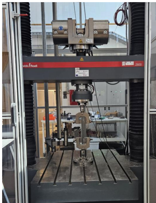
Slika 47: Uređaj za mjerenje vlačne sile (Autor: Nikolina Edjut)
