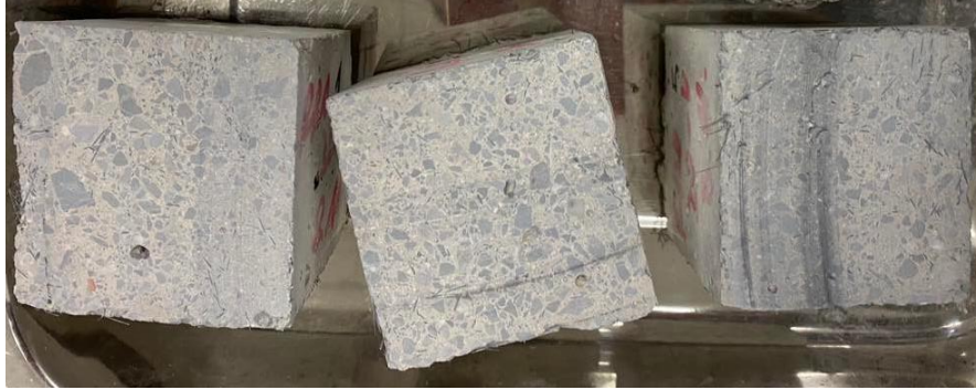
Slika 19: Prikaz uzoraka nakon 16 ciklusa habanja (Autor: Nikolina Edjut)
