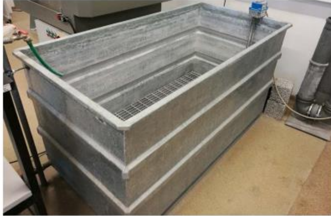
Slika 4: Bazen za njegu uzoraka [3]
