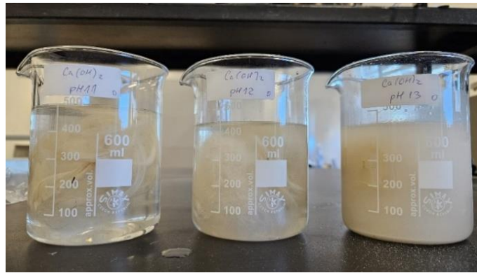
Slika 40: Otopine kalcijevog hidroksida i uronjena oprana vunena vlakna (Autor: Nikolina Edjut)
