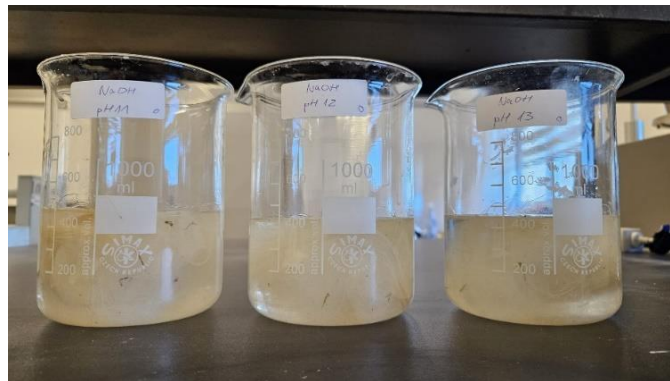
Slika 38: Otopine natrijevog hidroksida i uronjena oprana vunena vlakna (Autor: Nikolina Edjut)
