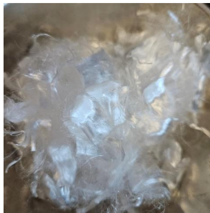
Slika 7: Polipropilenska vlakna (Autor: Nikolina Edjut)
