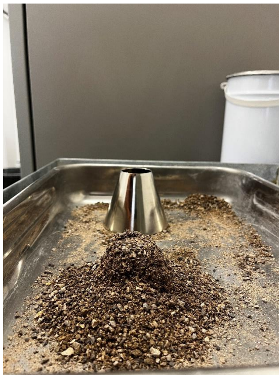
Slika 8: Zasićen površinski suh pijesak (izvor: vlastita fotografija)
