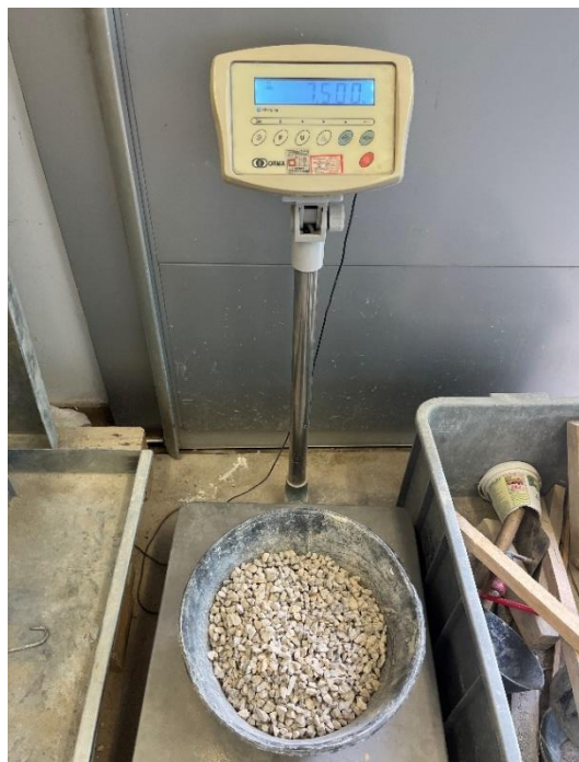
Slika 5: Vaganje prosijanog agregata na laboratorijskoj vagi (izvor: vlastita fotografija)
