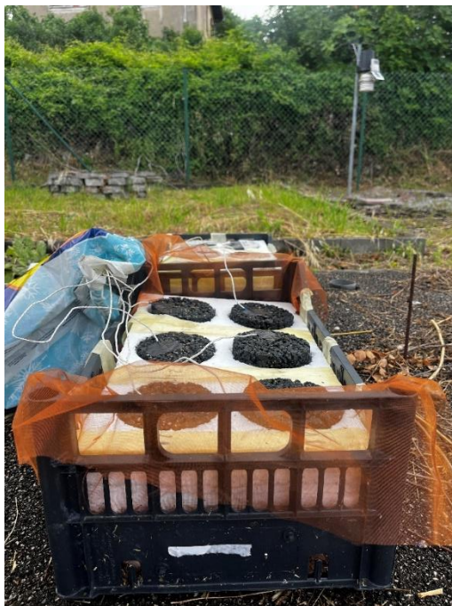
Slika 18: Kalupi za ispitivanje toplinskih karakteristika (izvor: vlastita fotografija)
