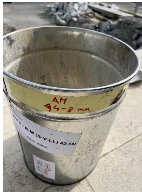
Slika 4: Posuda za odlaganje prosijanog agregata veličine zrna 4-8 mm (izvor: vlastita fotografija)
