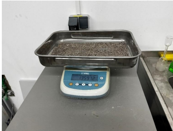
Slika 9: Vaganje potpuno suhog pijeska (izvor: vlastita fotografija)
