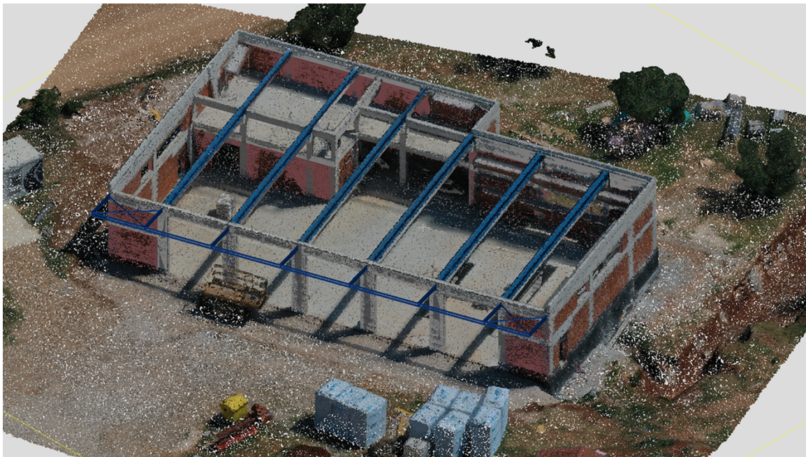
Slika 26 Preklapanje oblaka točaka i BIM modela Građevine 1
