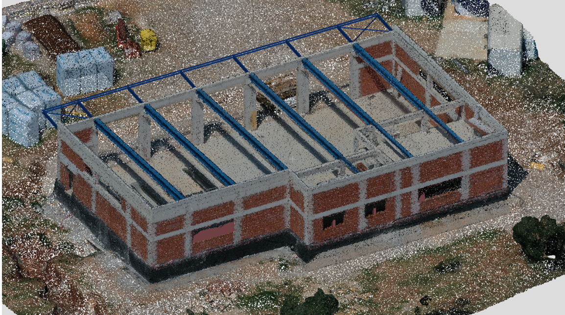
Slika 29 Preklapanje oblaka točaka i BIM modela Građevine 1
