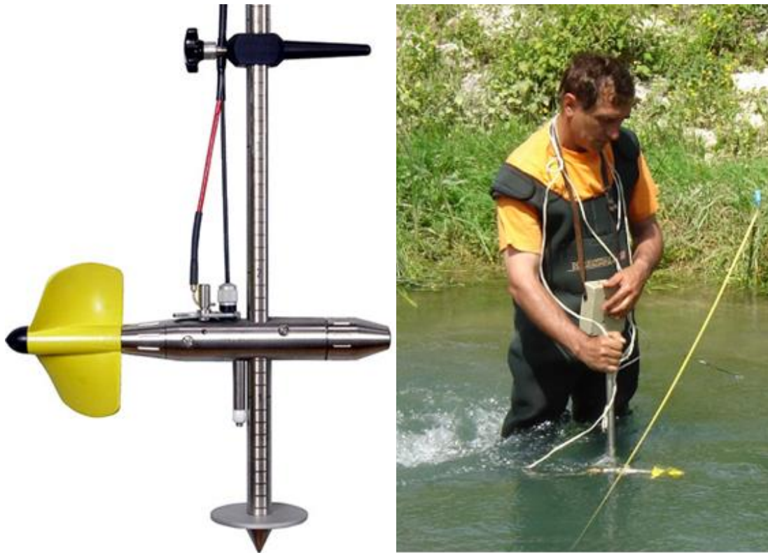
Slika 1. Hidrometrijsko krilo i njegova primjena u vodi [5], [1]
