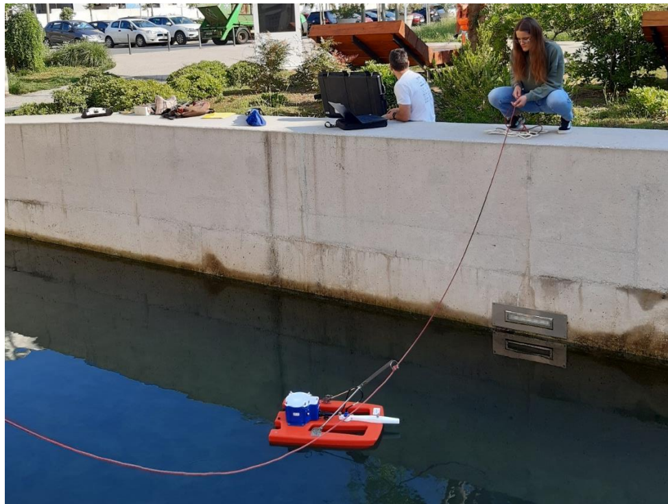
Slika 6. Mobilni način mjerenja strujanja vode ADCP uređajem (Slika autora.)
